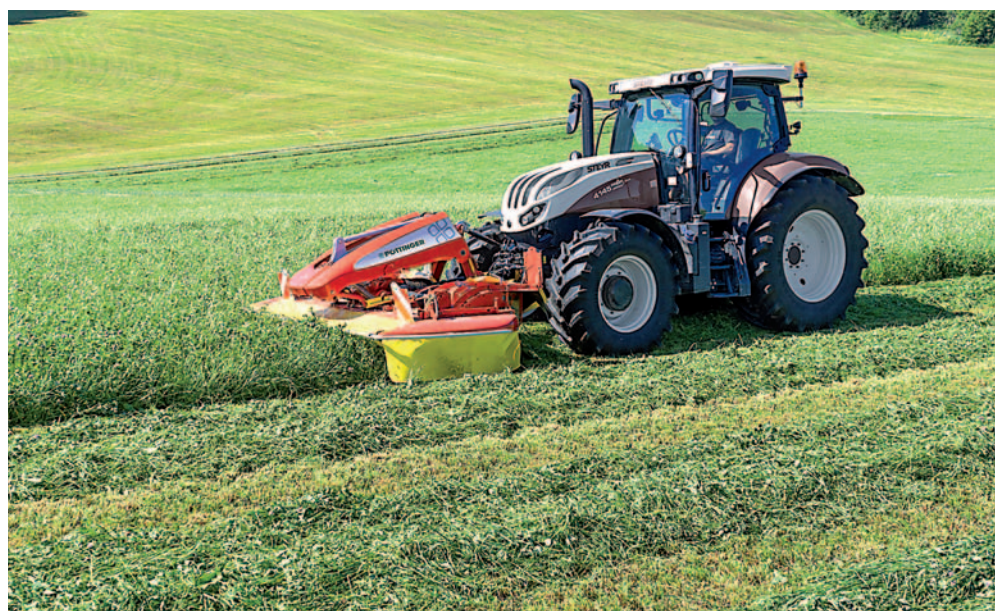
Specifickým znakem pro žací stroje v závěsu alpha-motion je jedinečná kinematika nosného rámu. Přítlak na žací nosník tak zůstává vždy na shodné úrovni a nedochází k poškozování travního drnu
