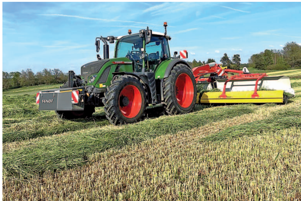
Pásový řádkovač Pöttinger Mergento VT 9220 se osvědčil i při shrnování travní píce na loukách a senážního žita
