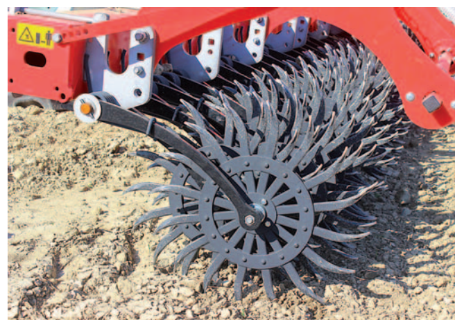
Rotační kultivátor Rotocare V 8000 dokáže svými samoostřícími hroty lopatek účinně rozrušit půdní krustu
