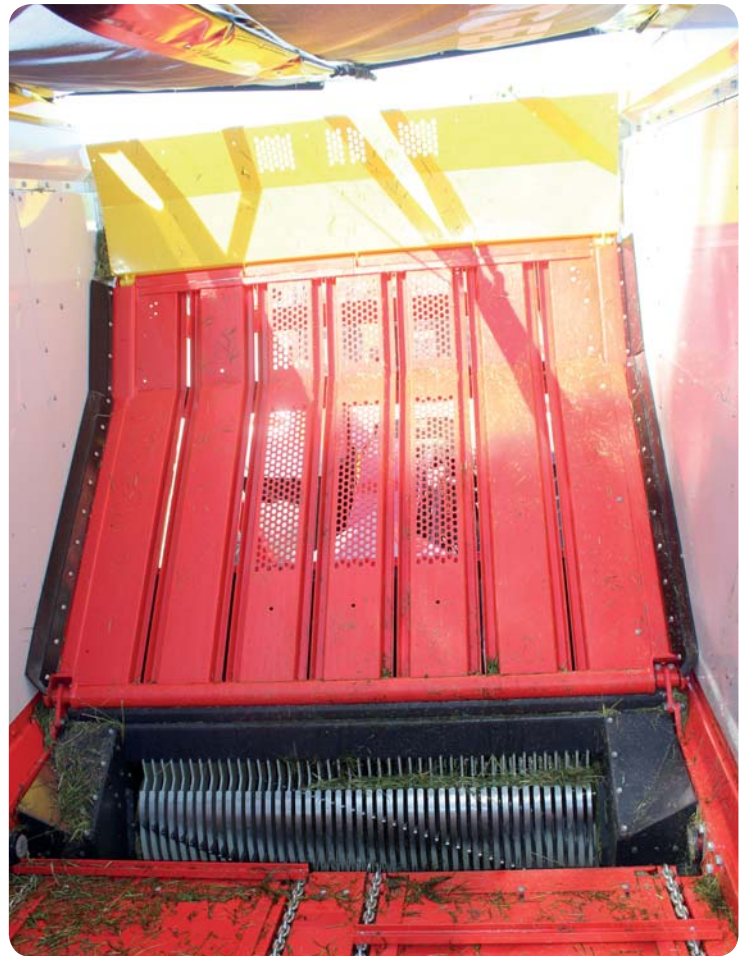
Jumbo 5000 má čelní výkyvnou stěnu ve standardní výbavě. Díky této stěně se objem ložné plochy zvětšuje o 4,3 krychlového metru při shodné délce návěsu
