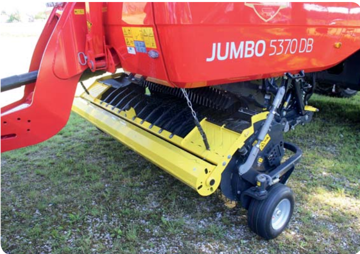
Prsty sběrače jsou skloněné lehce do dobíhavého pohybu, čímž se omezuje nebezpečí zapíchnutí do země, poškození travního drnu a znečišťování krmiva
