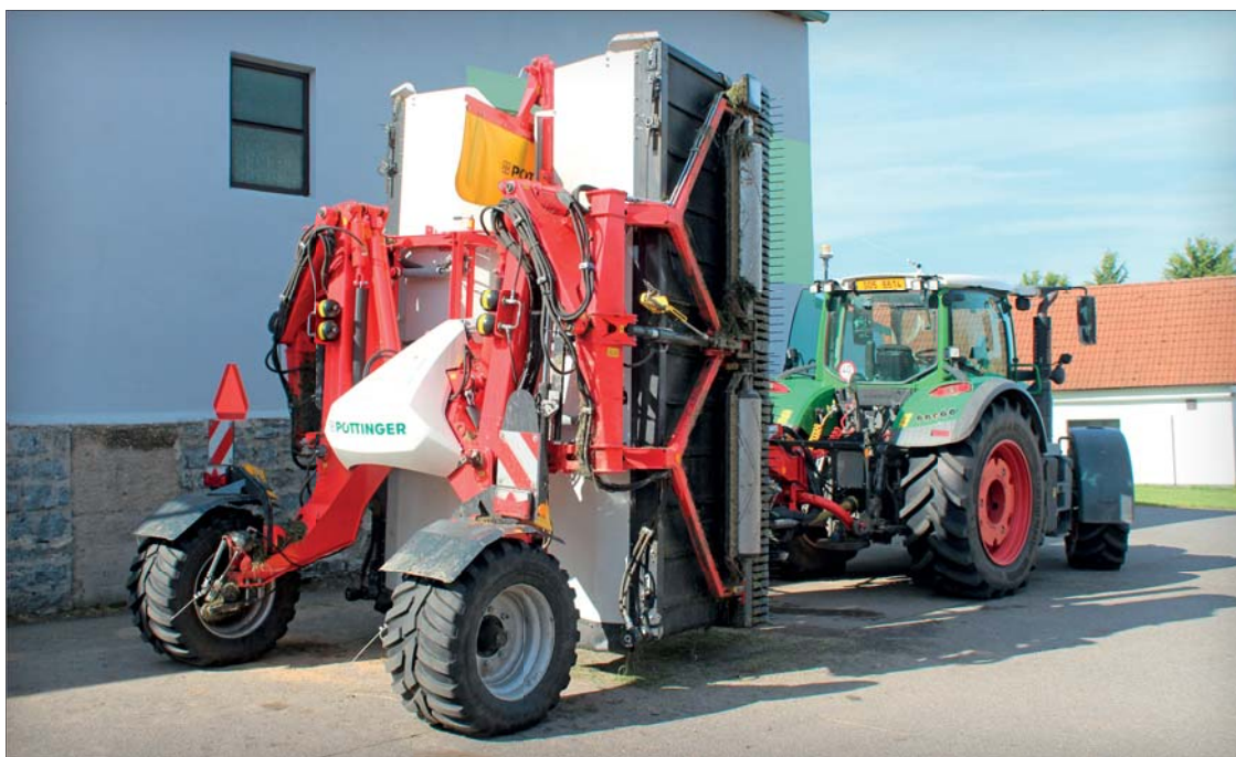
Pro přepravu jsou obě pásové jednotky složeny hydraulicky a automaticky zajištěny hydraulickým přepravním zámkem
