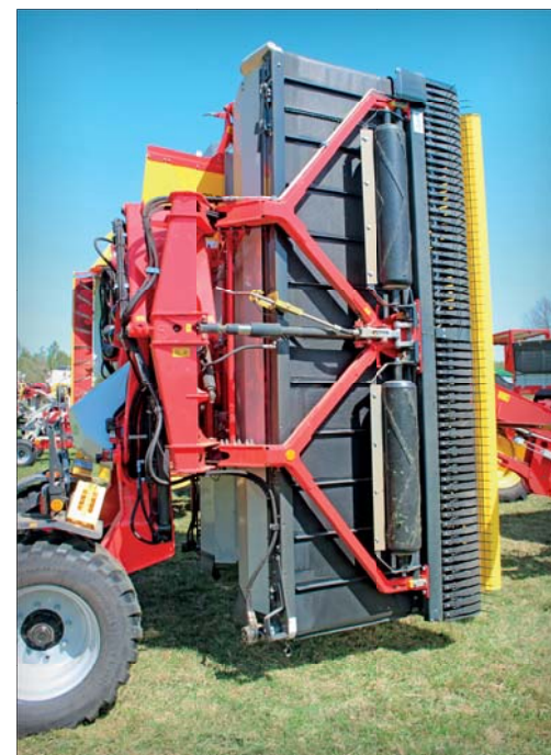
K čistotě práce přispívá i fakt, že pojezdové válečky se nacházejí v blízkosti záběru prstů sběrače a zaručují tak pro celý řádkovač ideální kopírování terénu
