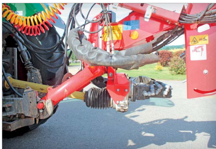
Mergento VT 9220 firmy Pöttinger se připojuje do spodních táhel tříbodového závěsu kategorie 3 N. Vývodový hřídel s otáčkami 540 ot/min (možných je i 540 E) pohání hydraulické čerpadlo, umístěné přímo na vstupním rámu. Sběrače i příčné dopravní pásy tak mohou být poháněny hydraulicky
