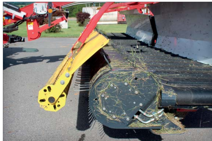
Řízený sběrač má poměrně velký průměr a šest řad prstů. Pokud by hmota měla tendenci od sběrače odskakovat dopředu, pak ji spolehlivě vrátí k prstům přítlačné válečky
