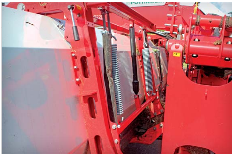
Plně pohyblivé centrální zavěšení pásových jednotek zajišťuje konstantní odlehčení po celém pracovním záběru. Odlehčení je mechanické pomocí vlnutých pružin
