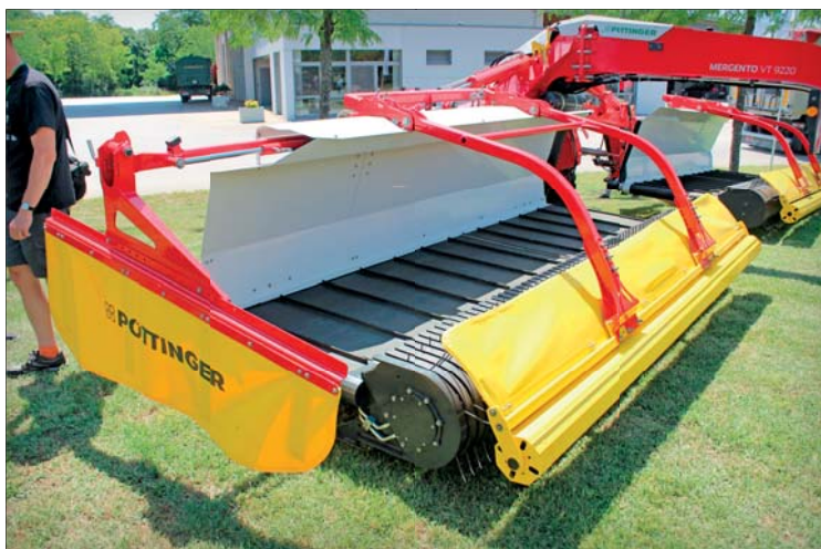
Při odtažení obou jednotek od sebe se hmota ukládá do středového řádku. Po přitažení obou jednotek k sobě proudí do řádku stranového, jehož šířku si lze nastavovat pomocí hydraulicky ovládané plachty
