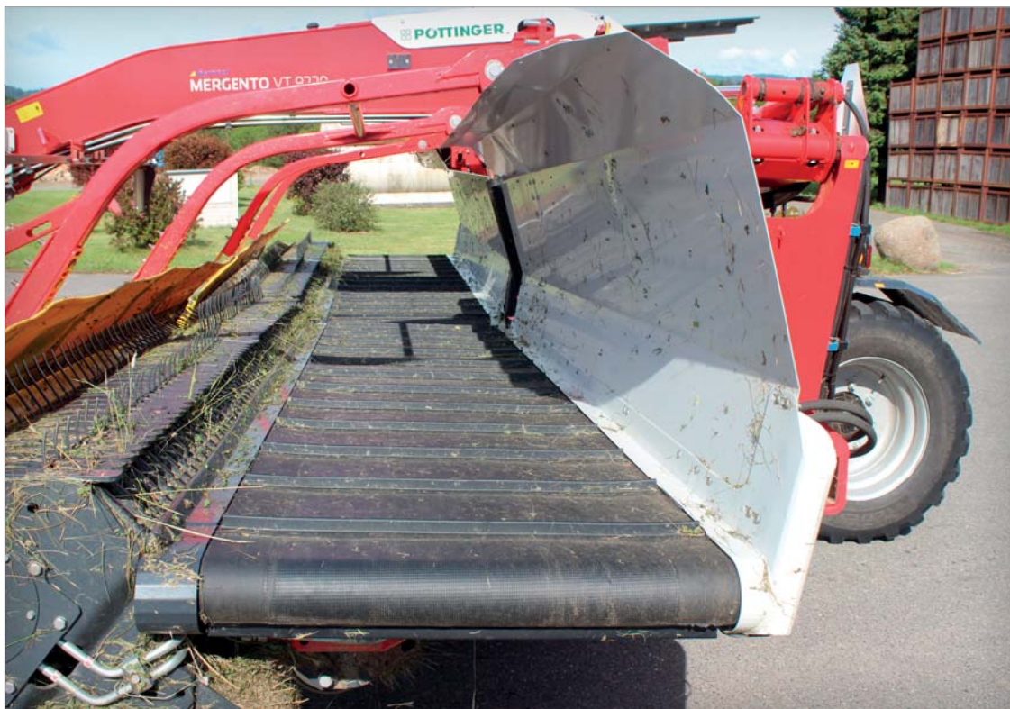
Robustně koncipované příčné dopravníkové pásy disponují značným výkonem. S příčníky spolehlivě přesouvají na řádek i suchou hmotu. Vysoká zadní stěna dále podporuje průchodnost
