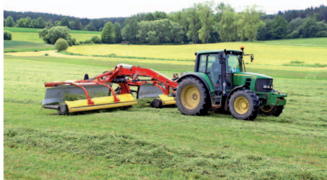
Řádkovač Mergento VT 9220 firmy Pöttinger zajistil snížení množství nečistot a kamenů v píce. Při sklizni sena a jetele je výhodou také snížení míry odrodu cenných částí rostlin
