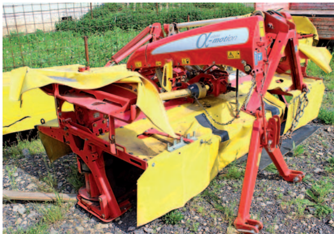
Specifickým znakem pro žací stroje v závěsu alpha-motion je jedinečná kinematika nosného rámu. Ten se při njetí do prohlubně spustí dolů a při njetí na vyvýšenou plochu zase zdvihne. Přítlak na žací nosník tak zůstává vždy na shodné úrovni
