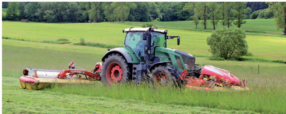
Žací kombinace NovaCat A10 má možnost stranového posunu až o 400 mm pro optimalizaci překrývání s čelně neseným žacím strojem. Na souvrati se může zdvihnout až o 55 cm
