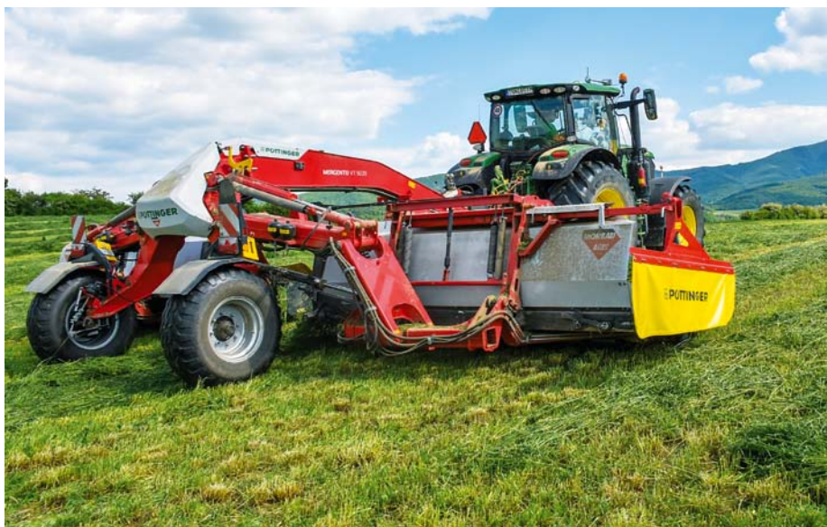
Riadkovacia plachta na pravej strane stroja pomáha vytvárať dokonale tvarovaný stranový riadok. Šírku riadku je možné pohodlne hydraulicky nastaviť zo sedadla traktora až do 1,40 m. Keď sa plachta nepoužíva, môžete ju jednoducho zložiť.
