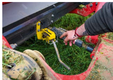
Výška oporných valcov s priemerom 22 cm reguluje výšku zberu od 0 až 11 cm. Nastavuje sa pomocou kluky.
