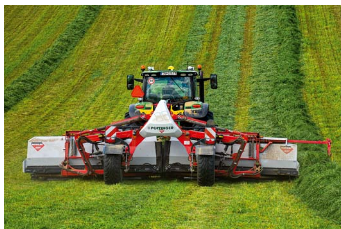
Tvorba riadku na pravej strane. Mergento umožňuje aj zber, keď sú pásky vypnuté. Takto dokážete preniesť obmedzené množstvo hmoty, napríklad z klinovitej časti pozemku, na iný riadok.
