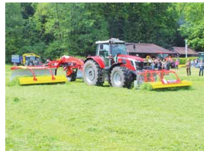
Na polním dnu byla předvedena zajímavá souprava, kdy byl tažen řádkovač Mergento VT 9220 doplněn o čelně nesené Mergento F 4010 Alpin
