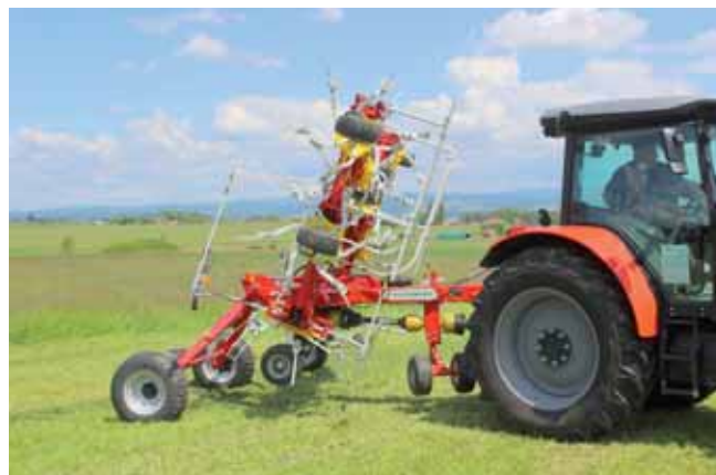
Polonesený obrabeč HIT 8.91 T s osmi rotory a pracovním záběrem 8,86 m má přepravní podvozek, který při přejezdech odlehčuje traktor a při práci je překlono-
