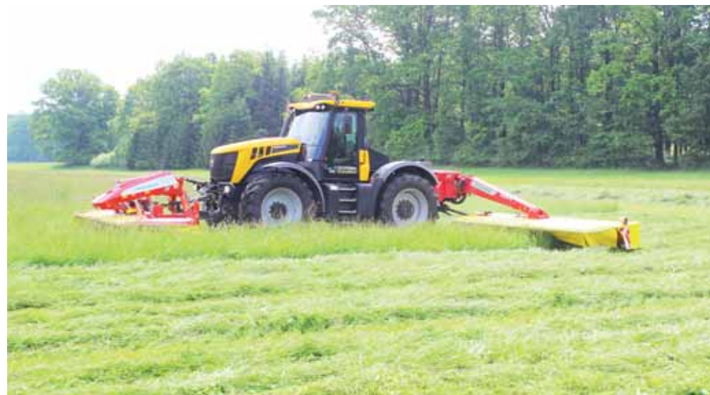
Žací trojkombinace Pöttinger NovaCat S12 poskytuje výhodu nízké energetické náročnosti, malé hmotnosti a velké plošné výkonnosti i přes sto hektarů za den
