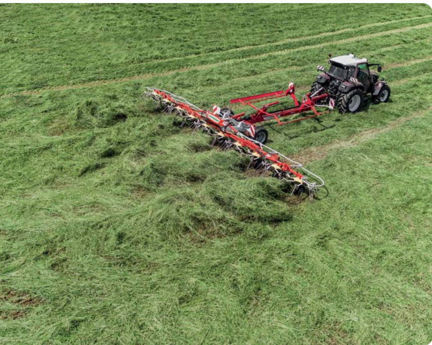
Polonesený obraceč HIT HT 11100 je osazen deseti rotory o průměru 1,42 m. Díky své nápravě může být agregován s lehčími traktory. A připojení k traktoru je výrazně jednodušší a rychlejší než u obraceče neseného
