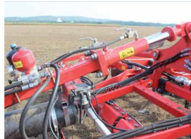
Systém trakčního posilovače Traction Control dokáže dlouhodobě přenášet na zadní kola traktoru až 1000kilogramový přitlak a tím snižovat prokluz kol
