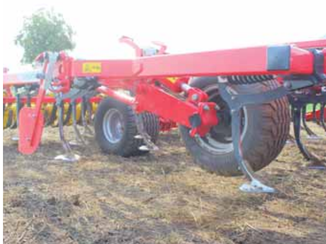
Hlavní předností tuhých slupic je stabilní záběr bez vychylování, což má pozitivní vliv na celoplošné podržnutí pozemku a na udržování pracovní hloubky na konstantní úrovni
