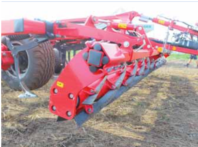
Řezací válec má spirálovitě uložené nože, čímž je zaručena velká kontaktní plocha nožů s půdou a účinný řez při rovnoměrném zatížení válce
