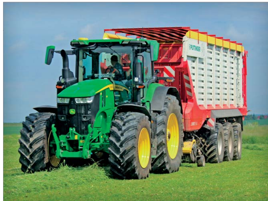
Jumbo 7540 má celou řadu pokrokových řešení, jako je hydraulický pohon sběrače či inteligentní čelní stěna, a může pracovat v agregaci s traktory o výkonu až 368 kW, tj. 500 koní
