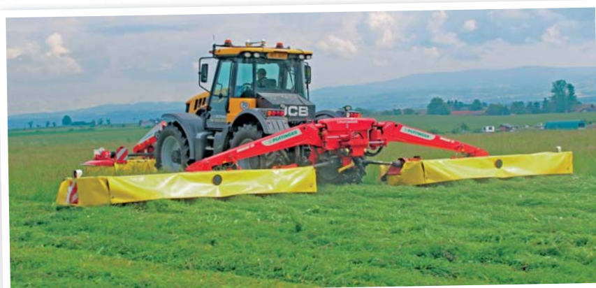
Žací trojkombinace Pöttinger NovaCat S12 poskytuje výhodu nízké energetické náročnosti, nízké hmotnosti a velké plošné výkonnosti i přes sto hektarů za den
