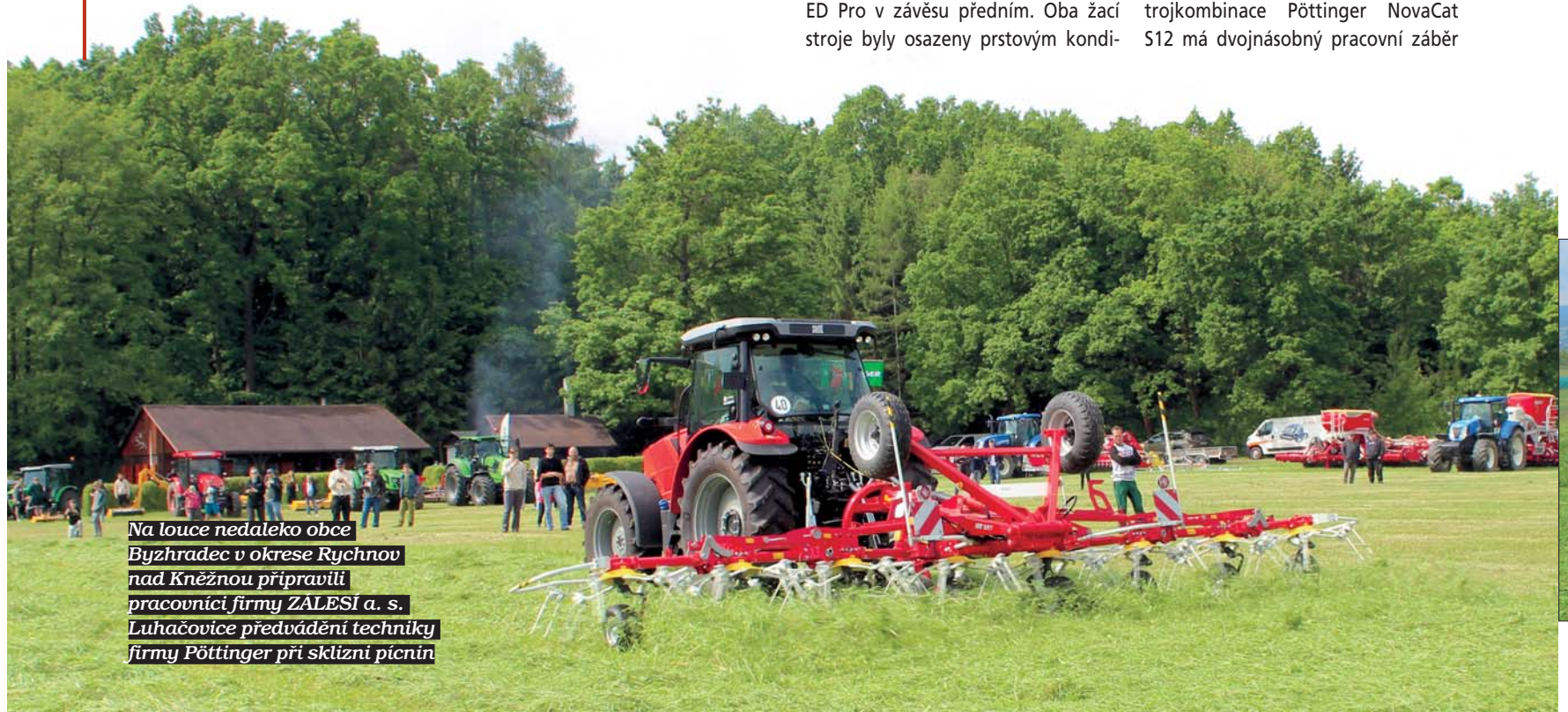
Polonesený obraceč HIT 8.91 T s osmi rotory a pracovním záběrem 8,86 m má přepravní podvozek, který je při práci překlopen nad rotory
