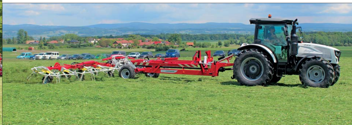
Pöttinger HIT HT 11100 je druhým modelem z řady vysoce výkonných obracečů píce – má deset rotorů a pracovní záběr 11 metrů
