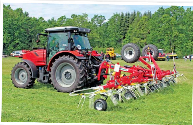
Polonesený obraceč HIT 8.91 T s osmi rotory a pracovním záběrem 8,86 m má přepravní podvozek, který je při práci překlopen nad rotory
