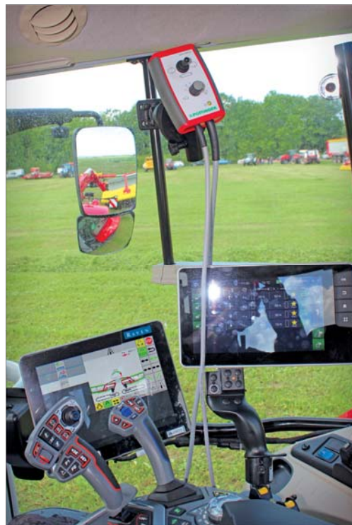
Řádkovač Mergento VT 9220 byl ovládaný pomocí ISOBUS na velkém terminálu Raven, čelně nesené Mergento F 4010 Alpin pak předvolbovým ovládáním nahoře
