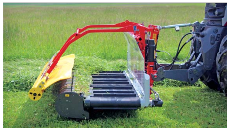
Čelně nesený pásový řádkovač Mergento F 4010 Alpin se vyznačuje nízkou hmotností. Kvalitně formované řádky jsou výsledkem dobře vyřešené dopravníkové jednotky, sestávající ze sběrače, přitlačného válečku a příčného pásu
