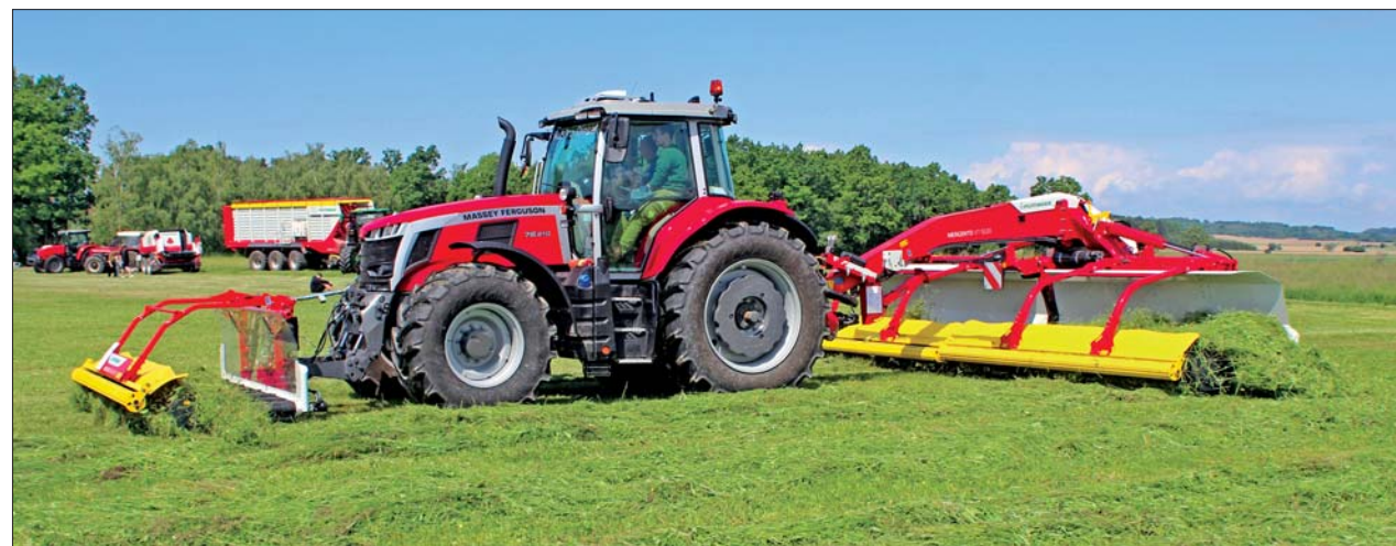
Na Polním dnu byla předvedena zajímavá souprava, kdy byl tažený řádkovač Mergento VT 9220 doplněn o čelně nesené Mergento F 4010 Alpin. Na obrázku je souprava pracující tak, že odkládá jeden stranový řádek
