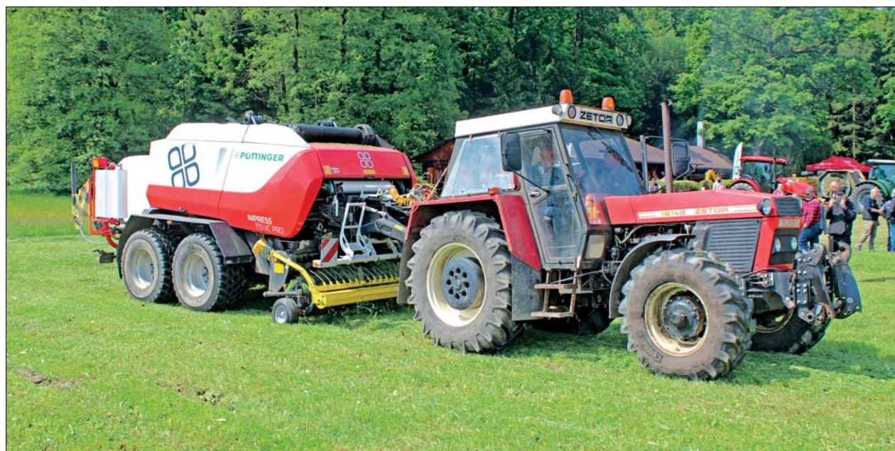
Nařezání píce 32nožovou řezací jednotkou a pohon dalších funkcí již vyžadují dostatečný výkon, ale Zetor 16145 si před lisem Pöttinger Impress 155 VC Pro vedl statečně
