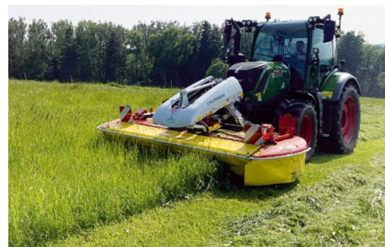
Čelný žací stroj NOVACAT 301 ALPHA MOTION MASTER zaujme extrémne krátkou konštrukciou s patentovaným uchytaním žacej lišty pre dokonalé kopírovanie nerovností.
