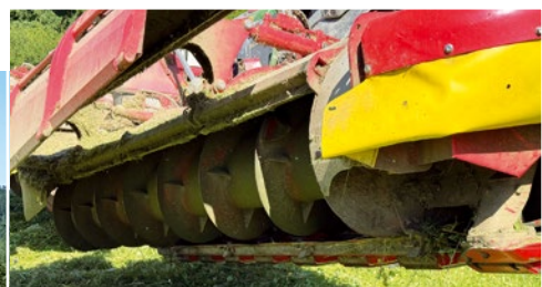
Žací kombinace NOVACAT V 9200 CF se šnekovými dopravníky CROSS FLOW.
