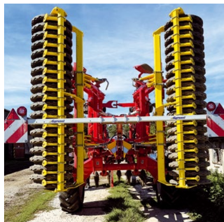
Tažený radličkový podmiřák / kypřič TERRIA 5030, v třířadím provedení s pracovním záběrem pět metrů pořídila společnost Vacek agro v letošním roce. Určený je pro mělké i hlubší kypření (od 5 až do 35 cm) a nabízí všestranné řešení pro různé půdní typy. S radličkami DURASTAR PLUS s tvrdokovem je vhodný i do tamních kamenitých podmínek.
