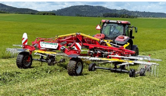
Dvojrotorový stredový zhrňovač TOP 882 C s hydraulicky nastaviteľným pracovným záberom 7,7 až 8,8 metra, čo umožňuje rýchle a jednoduché prispôsobenie šírky zhrňovania.
