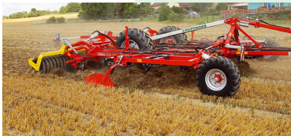
Tažený radličkový podmiřák / kypřič TERRIA 5030, v třířadím provedení s pracovním záběrem pět metrů pořídila společnost Vacek agro v letošním roce. Určený je pro mělké i hlubší kypření (od 5 až do 35 cm) a nabízí všestranné řešení pro různé půdní typy. S radličkami DURASTAR PLUS s tvrdokovem je vhodný i do tamních kamenitých podmínek.
