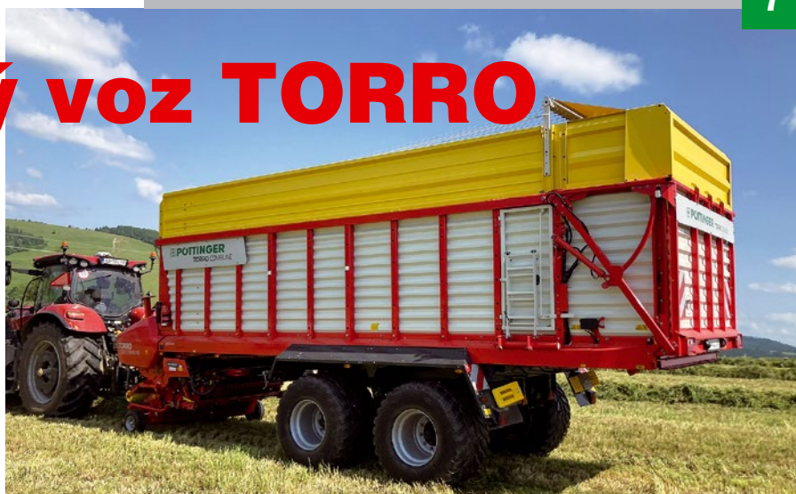
TORRO 7010 L COMBILINE s objemom 40 m 3 je flexibilný senážny voz pre nasadenie podľa podmienok – zber senáže, sena a slamy alebo doprava objemových materiálov. Vybavený je automatickou brúskou AUTOCUT, nožími DURASTAR s oteruvzdorným povlakom pre podstatné predĺženie ich životnosti.
