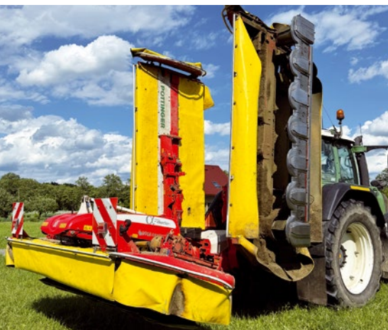
Výkonná žací kombinace NOVACAT X8 s pracovním záběrem 8,30 metru pracuje s traktorem 250 k s otočným řízením, což znamená úsporu času a šetří se tím i technika. Spotřeba se pohybuje 3,5 až 4 litry nafty na hektar včetně dopravy.
