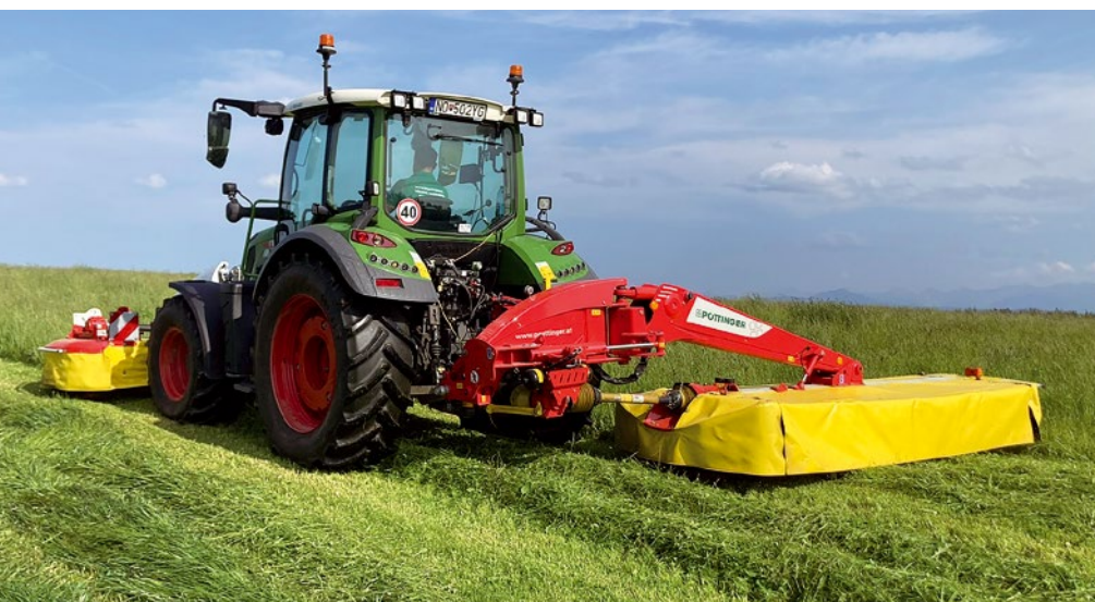
Žacia kombinácia, ktorú tvorí čelný žací stroj NOVACAT 301 ALPHA MOTION MASTER v kombinácii so zadným diskovým žacím strojom NOVACAT 352, má pracovný záber 6 metrov.
