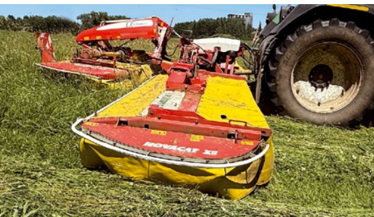
Výkonná žací kombinace NOVACAT X8 s pracovním záběrem 8,30 metru pracuje s traktorem 250 k s otočným řízením, což znamená úsporu času a šetří se tím i technika. Spotřeba se pohybuje 3,5 až 4 litry nafty na hektar včetně dopravy.
