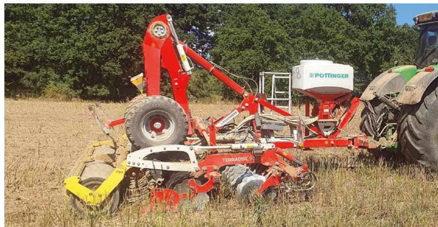
Diskový podmiťáč TERRADISC 5001 T kombinují podle potřeby se secím strojem TEGOSEM 500 a využívají ho na přesevu tzv. zeleného úhoru.
