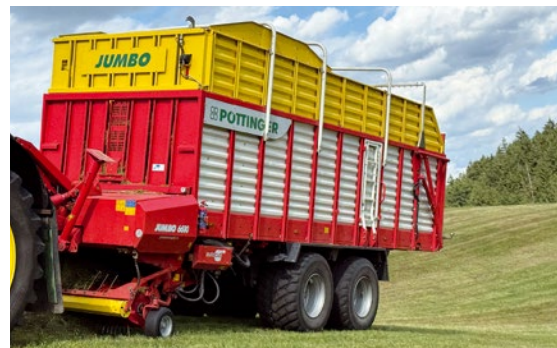
Vůz JUMBO 6610 L s automatickým broušením nožů AUTOCUT sklízí hlavně píci na senáž.
