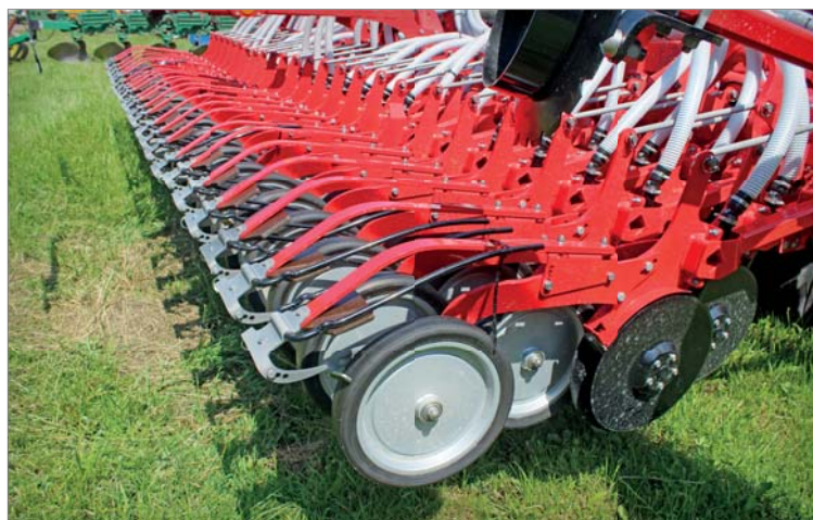
Talíře pro přípravu půdy, botky pro přihnojování i secí botky jsou uspořádány symetricky, tj. v zrcadlovém uspořádání levé a pravé strany – u všech variant secích strojů Terrasem nové generace. Na obrázku jsou secí botky s opěrnými kolečky v plném ocelovém provedení, vhodné do horších podmínek
