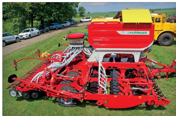
Nový Pöttinger Terrasem V 6000 DZ měl svůj velkokapacitní zásobník se shodnou kapacitou 4200 litrů v dvoukomorovém provedení. Zásobník s pevným dělením v poměru 60 : 40 lze i kompletně využít k uložení jednoho druhu osiva
