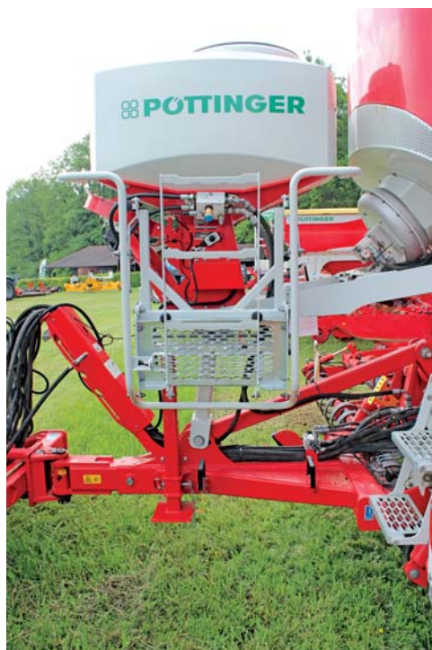
Zajímavostí vystaveného secího stroje Terrasem V 6000 D byl instalovaný secí stroj Tegosem 500 jako druhý zásobník. Ten má v kabině traktoru vlastní ovládací terminál
