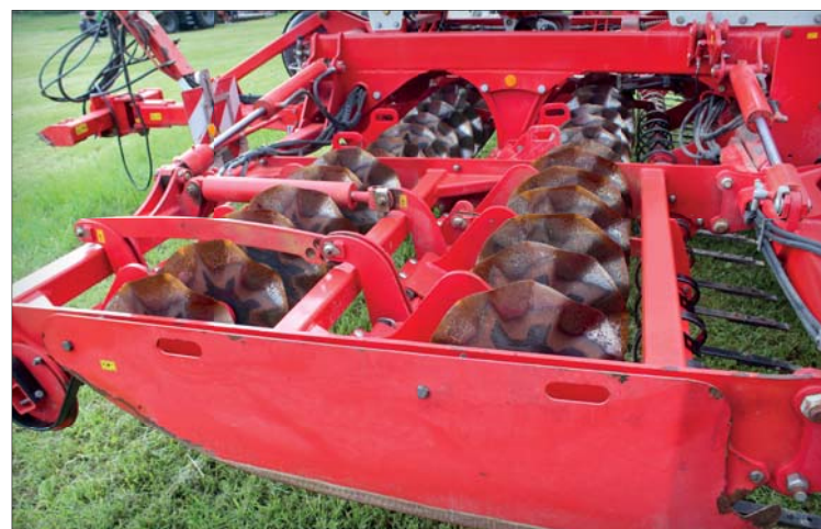
Zvlněné talíře Wave disc jsou usazeny tak, aby prováděly přípravu půdy v pruzích s roztečí 125 anebo 167 milimetrů, odpovídající roztečím secích btek. Prostor mezi nakypřenými pruhy zůstává nezpracovaný
