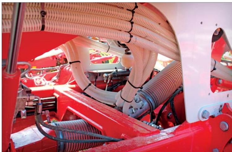
Detail vyústění semenovodných hadic stroje Tegosem do trubice, vedoucí osivo od dávkovacích ústrojí do secích btek. Je-li zvolena tato možnost, pak se osivo či hnojivo z Tegosemu ukládá do výsevní rýhy společně s osivem ze zásobníku
