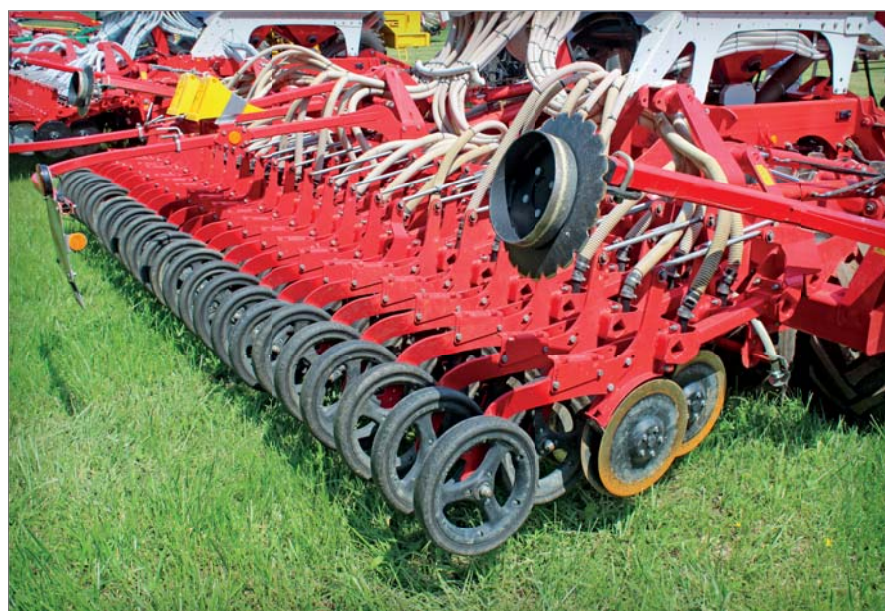
I poslední sekce Terrasemu nabídla porovnání dvou variant, a to opěrných koleček secích botek: opěrná kolečka v provedení loukoťovém jsou běžnější, než v plném ocelovém provedení
