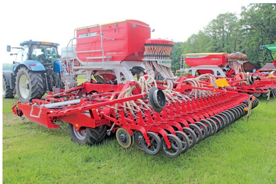
Secí stroje nejnovější generace prozrazuje i jejich modernizovaný design. Nově koncipovaný zásobník má větší objem, nápadná je též praktická stranová plnicí lávka s protiskluzovými schůdky a robustním zábradlím
