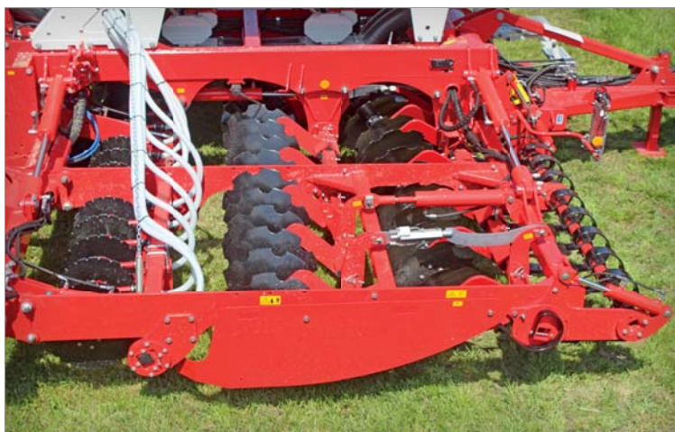
Talíře pro přípravu půdy, botky pro přihnojování i secí botky jsou uspořádány symetricky, tj. v zrcadlovém uspořádání levé a pravé strany – u všech variant secích strojů Terrasem nové generace. Na obrázku jsou secí botky s opěrnými kolečky v plném ocelovém provedení, vhodné do horších podmínek
