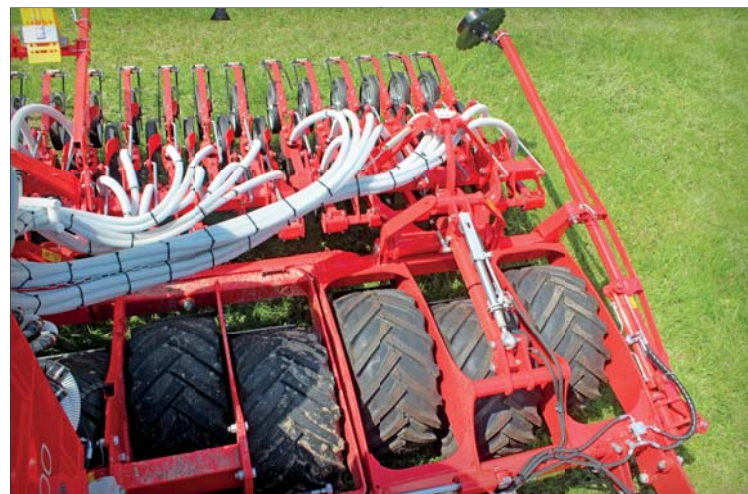
Na širokých pneumatikách se celý stroj na poli pohybuje lehce, čemuž napomáhá i fakt, že se ani na kypré půdě před pneumatikami v přesazeném uspořádání netvoří val půdy. Zároveň je stroj při práci klidný a bez vibrací
