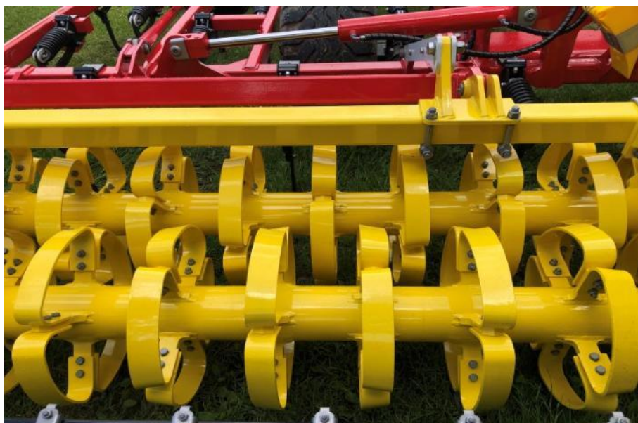
Zadní utužovací válec. Volitelně lze objednat různé varianty válce např. tandemový Conoroll, segmentový Conoroll, gumový mačkáč válce nebo tandemový válec profilu U.
