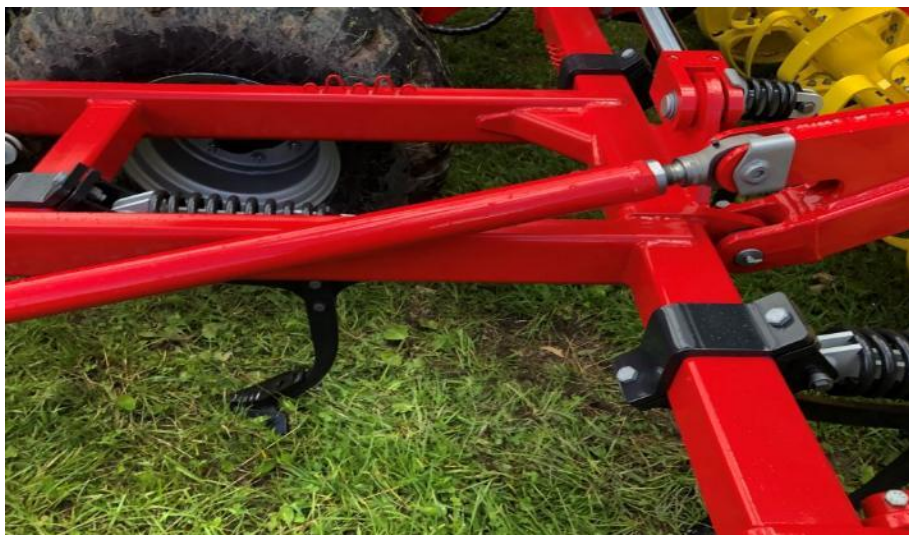
Táhlo pro nastavení hloubky zpracování půdy pomocí zadního válce.
