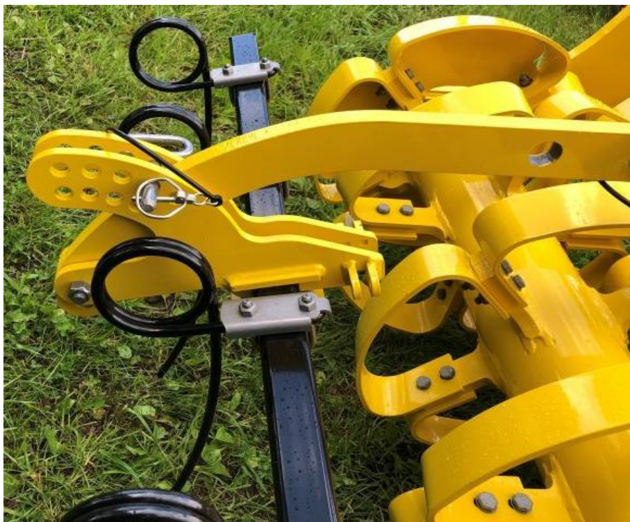
Nastavení zavlačovacích prutů na sklápěných křídlech.
