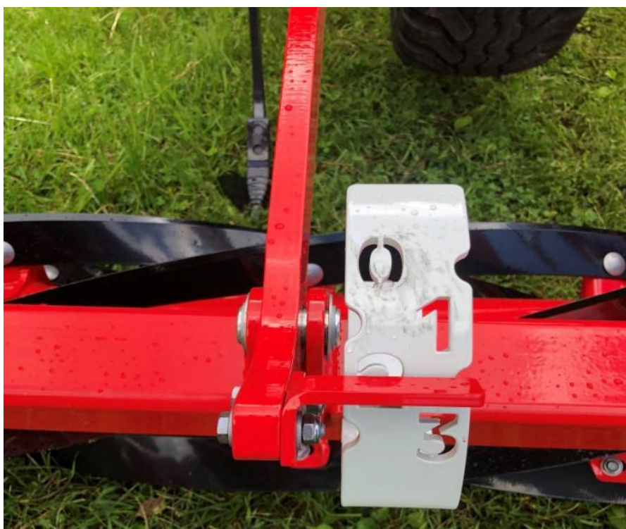
Ukazatel hloubky předního řezacího válce.
