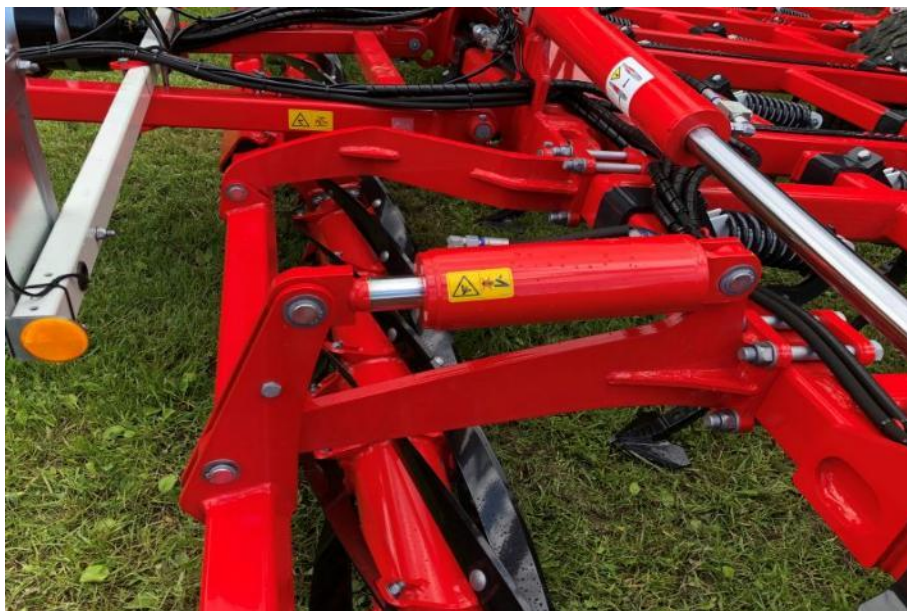
Hydraulický válec předního řezacího válce.
