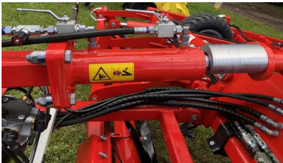
Hydraulický válec oje s možností nastavení polohy tažné oje.
