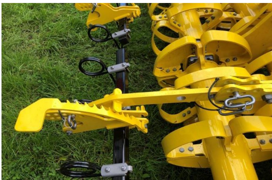
Nastavení zadních zavláčovacích prutů.
