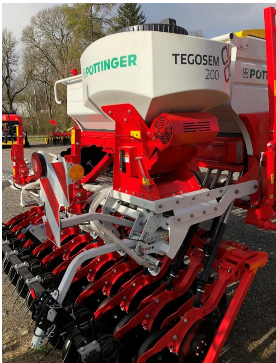
Silné zavlačovací pruty se spirálovým pružinovým vinutím pro perfektní práci. Bezúdržbová konstrukce s gumovými tlumiči. Pojistka pro ochranu před poškozením při jízdě zpět.
