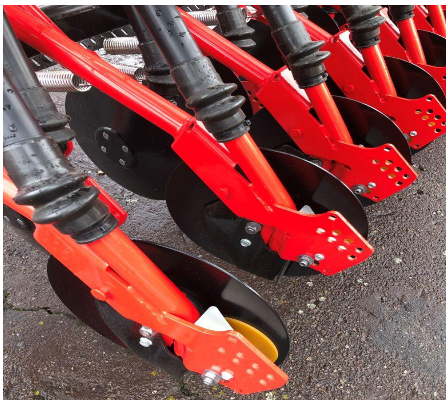
Jednodiskové botky. Vhodné do podmínek s velkým množstvím organické hmoty. V závislosti na modelu a pracovním záběru je rozteč řádků 12,0 cm, 13,2 cm, 14,3 cm nebo 14,8 cm. Maximální přítlak botek 25 kg. Robustní koncept pro maximální odolnost.
