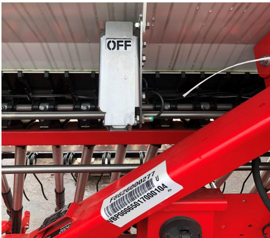
Mechanismus řazení kolejových řádků.
