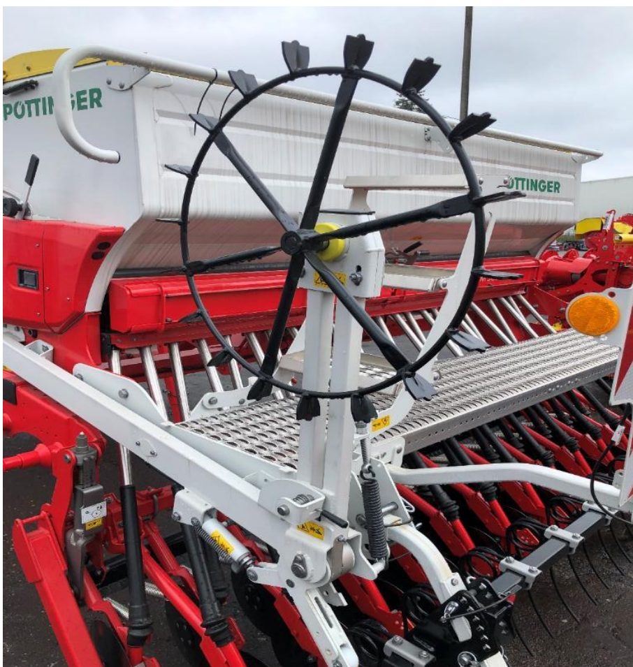
Dávkovací hřídel je standardně poháněna ostruhovým kolem, které je umístěno uvnitř pracovního záběru.
