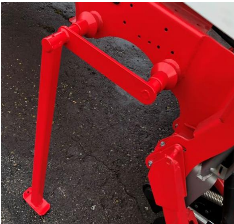
Přední odstavné patky secího stroje. Po odpojení secího stroje od přípravy půdy lze nářadí FOX nebo rotační brány LION používat samostatně.
