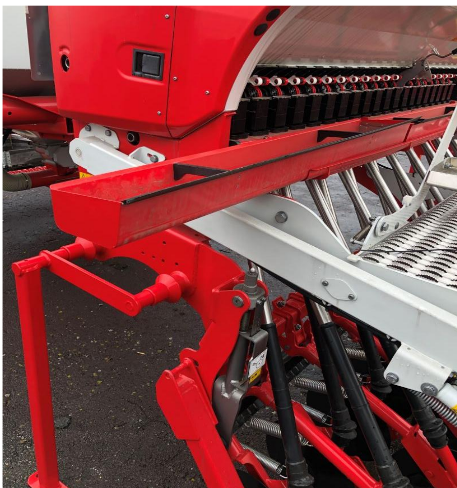
Pro Váš maximální pracovní komfort byl vylepšený přístup k vaničkám. Na jedné straně lze kalibrační vaničky pohodlně stranově vysunout.
