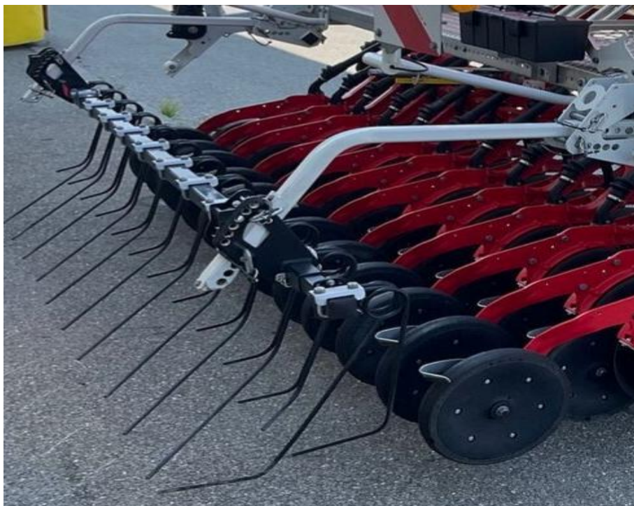
Silné zavlačovací pruty se spirálovým pružinovým vinutím pro perfektní práci. Bezúdržbová konstrukce s gumovými tlumiči. Pojistka pro ochranu před poškozením při jízdě zpět.
