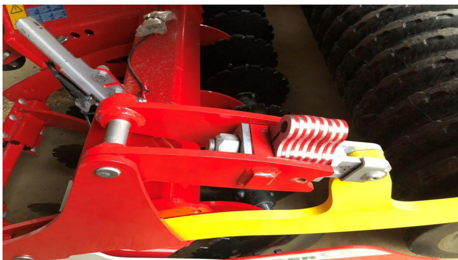
Nastavení hloubky přípravy půdy.
