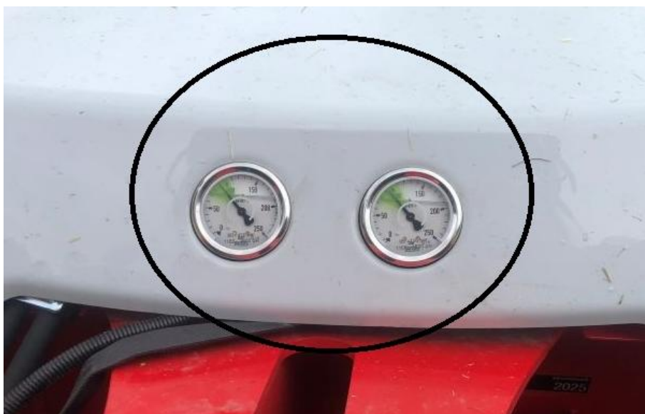
Manometry hydraulického odlehčení.
