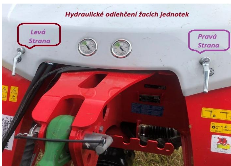
Plynule nastavitelné hydraulické odlehčení pro kvalitní kopírování nerovností v celém záběru stroje. „Plovoucí řez“ je již dlouhodobým znakem žacích strojů PÖTTINGER. Přítlak lze odečíst pomocí manometru.
