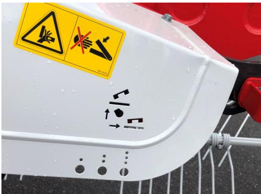
Označení místa pro nastavení výšky zdvihu zadních rotorů a šířky řádku.
