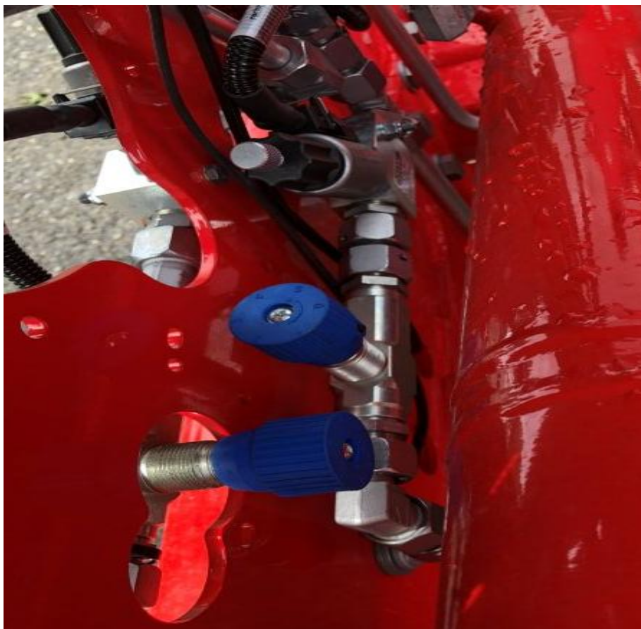
Ventily na úpravu rychlosti klesání předních rotorů.
