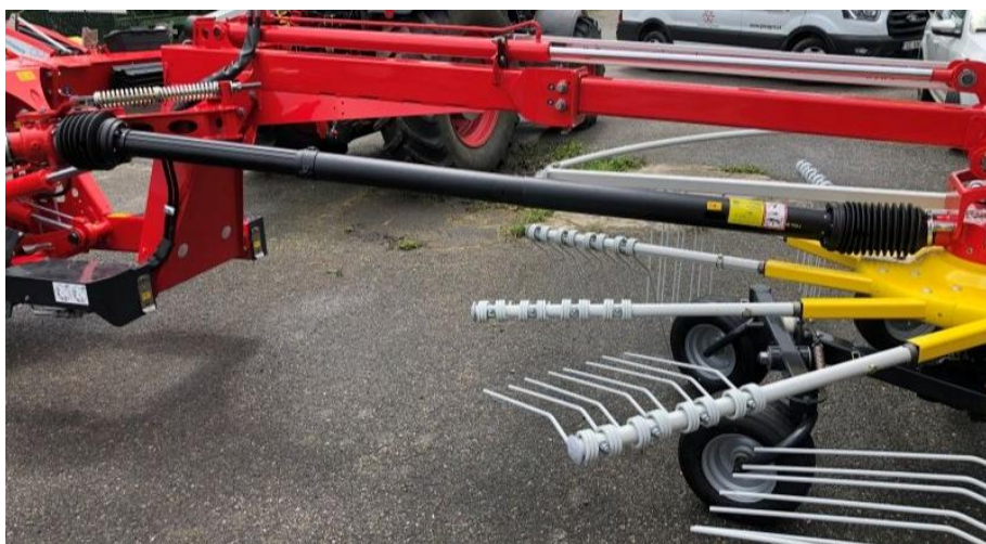
Kardanový pohon předního rotoru.
