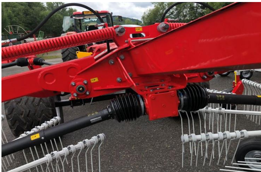
Převodovka pohonu zadních rotorů.
