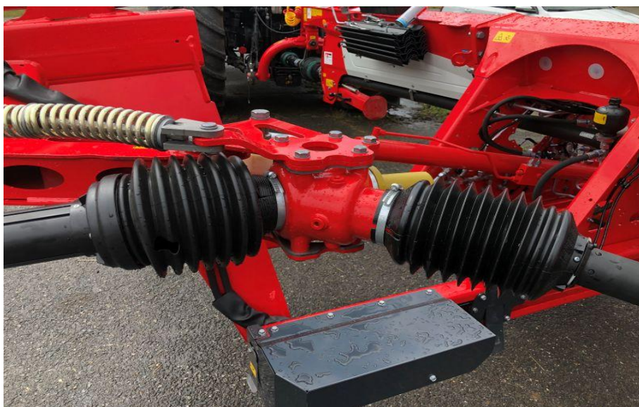
Převodovka pohonu předních rotorů.
