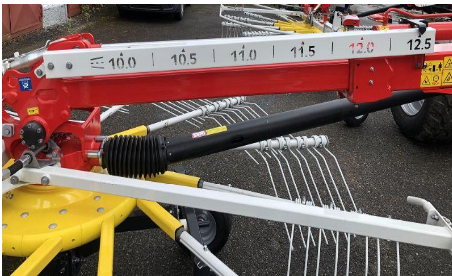
Stupnice nastavení pracovního záběru. Označení záběru rotoru při skládání do transportu. Stroj musí být stažen na nejužší záběr.
