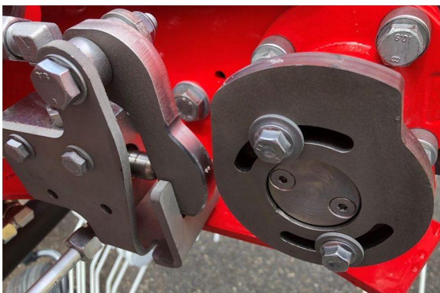
Nastavení zdvihu zadních rotoru při otáčení na úvrati.
