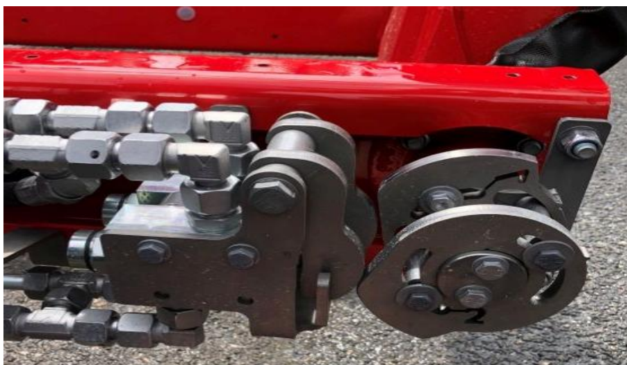
Nastavení výšky předních rotorů při úvratové poloze a časování rotorů. Nastavení zpoždění mezi předními a zadními rotory při najíždění a vyjíždění z řádku.
