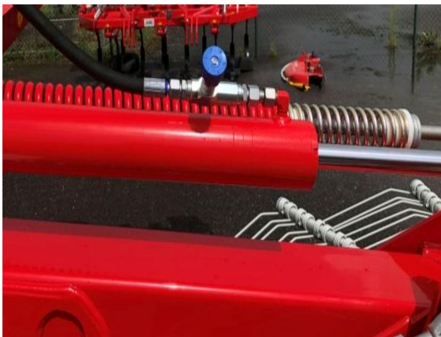
Ventil nastavení klesání zadních rotorů.
