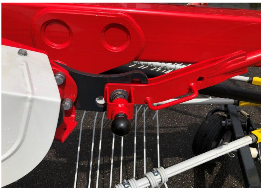
Mechanismus pro nastavení šířky řádku. Nastavení se provede v transportní poloze stroje.
