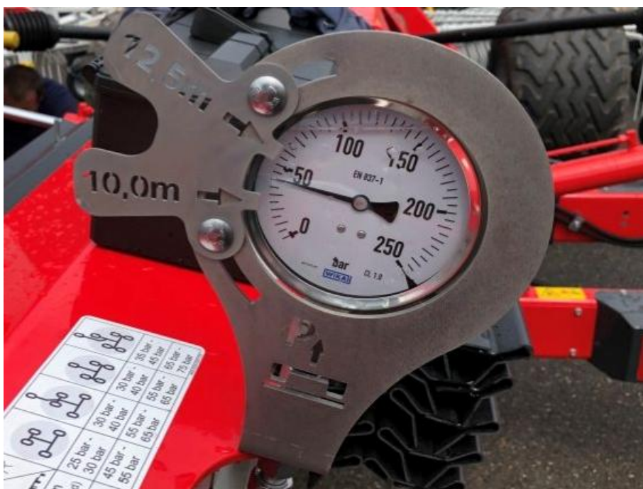
Manometr odlehčení rotorů. Označena pracovní šířka deset a dvanáct a půl metru. Dva přední rotory jsou odlehčené hydraulicky. S předvolbovým ovládáním Select lze na manometru odečíst odlehčovací tlak.
