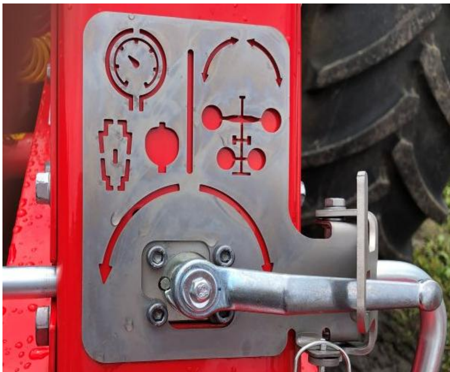
Třícestný kohout. Nastavení odlehčení rotorů - kohout vlevo a kohout vpravo - pracovní poloha.
