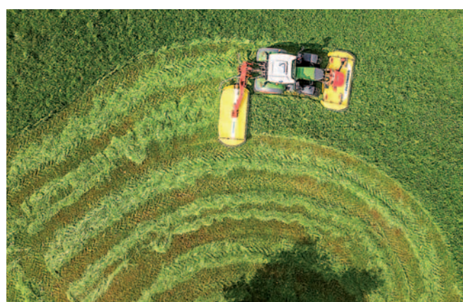
S komfortním ovládáním Profiline se nyní čelní žací lišta Novacat F 3100 Opticurve automaticky natáčí doleva nebo doprava v závislosti na úhlu natočení traktoru nebo sklonu svahu
