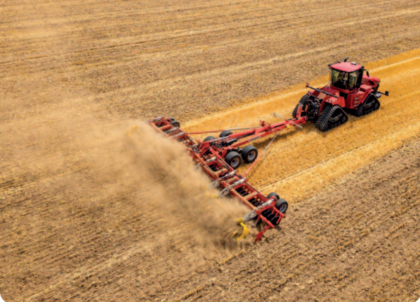
Nové talířové brány Terradisc HT 12000 jsou univerzálně využitelné – ať už při podmtíce strniště, nebo při přípravě setového lůžka, v těžkých a suchých podmínkách nebo při velkém množství posklizňových zbytků
