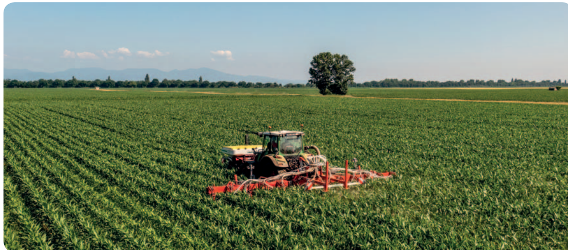
Nejdůležitější novinkou u plečky Flexcare V je pneumatický rozdělovací systém, který ve spojení se secím strojem s čelním zásobníkem Amico F umožňuje například cílenou aplikaci hnojiv současně s kultivací porostu
