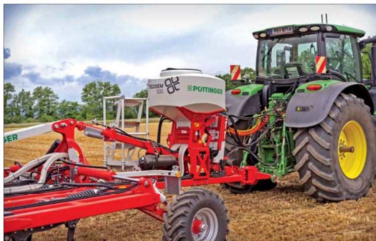
Dva dávkovací válečky v základní výbavě secího stroje Pöttinger Tegosem dovolují přesné dávkování jemného i hrubého osiva, a to i při malých výsevcích
