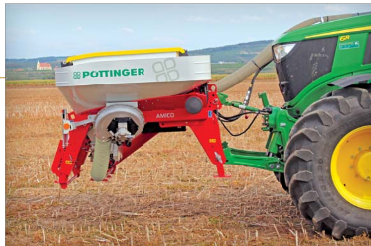
Čelní zásobník Amico F může být vyroben s objemem 1700 anebo 2400 litrů. Tento objem je rozdělen na dvě komory v poměru 60 : 40
