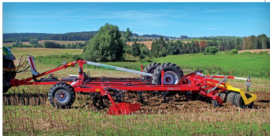
Pod označením Terria se skrývají těžké kypřiče s vysoce robustní konstrukcí, vhodné i do obtížných podmínek pro kolové i pásové traktory s výkonem i nad 500 k
