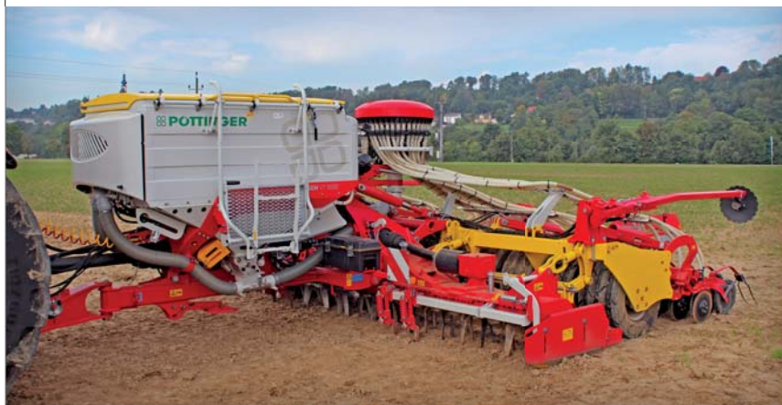
Pöttinger Aerosem VT 5000 DD je kompaktní secí kombinace s aktivní přípravou půdy a opěrným válcem. Přetlakový zásobník s dvojím dávkovacím ústrojím umožňuje flexibilní využití
