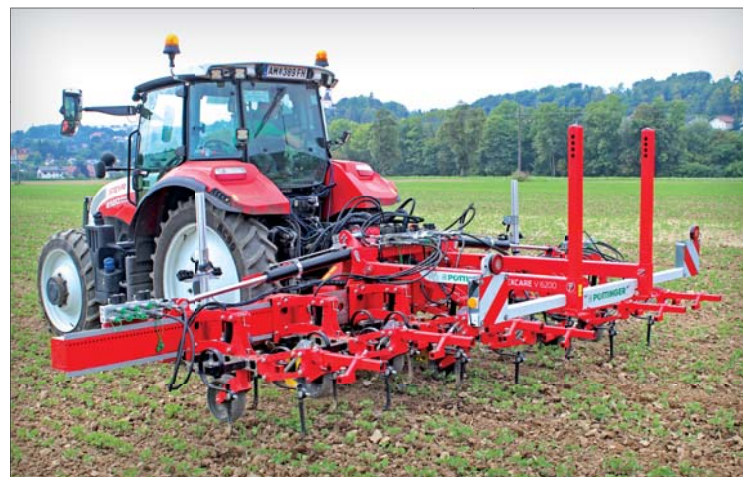
Eliminaci půdního škraloupu, nakypření půdy a obnovení přístupu vzduchu a vláhy ke kořenům spolu s likvidací plevelů lze provést při jednom přejezdu s radličkovou plečkou Pöttinger Flexcare V
