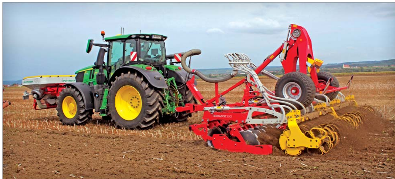
V roce 2024 představila firma Pöttinger využití zásobníku Amico F i v kombinaci s taženým podmiťčem Terradisc 6001 T. Koncovky pro ukládání hnojiva jsou v případě krátkých talířových bran uloženy před operním válcem
