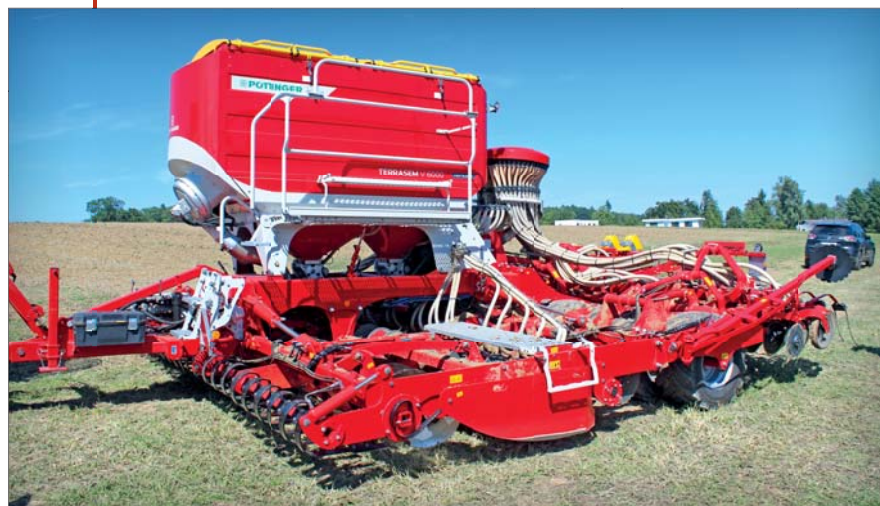
Efektivitu práce všech secích strojů Terrasem nové generace zvyšuje nově pojaté, symetrické uspořádání pracovních orgánů. Toto symetrické uspořádání do písmene X se týká jak talířů pro přípravu půdy, tak i secích btek
