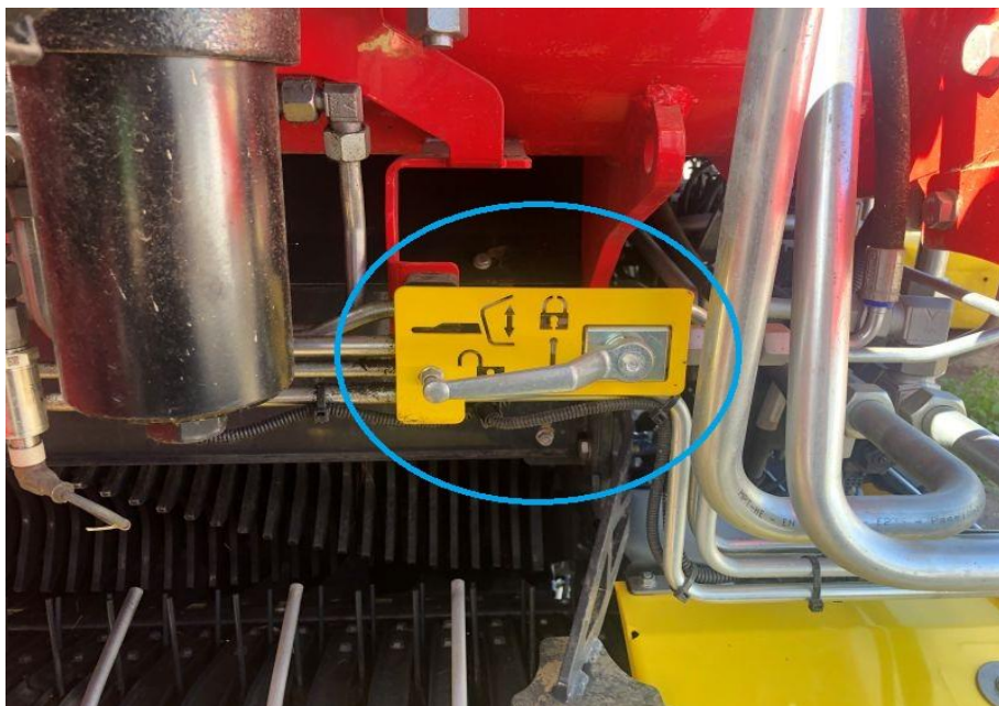
Ventil pro zajištění tažné oje.
