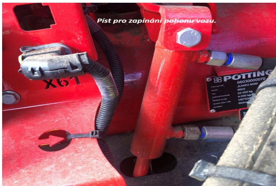
Hydraulický válec pro spuštění pohonu vkládacího rotoru.
