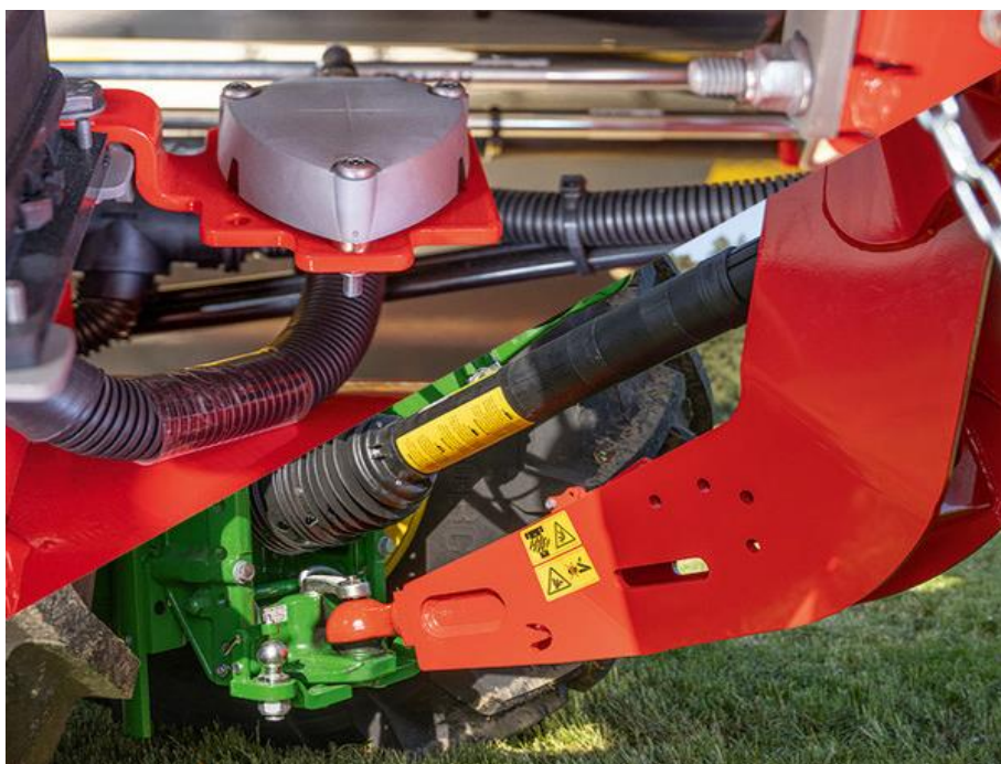
S asistenčním systémem řidiče „inteligentní vlečná náprava“ detekuje vůz automaticky pohyb. Tandemový inteligentní podvozek Vám umožní automaticky uzamknout zadní nápravu za všech
