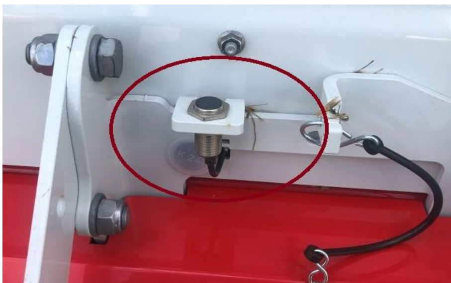
Senzor bočních dveří. Při otevření bočního vstupu je nulová funkce všech hydraulických funkcí.
