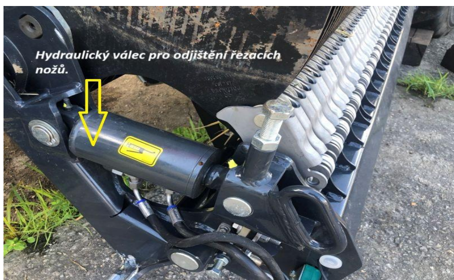
Centrální hydraulické uvolnění nožů je v základní výbavě. Pomocí tlačítka lze nože automaticky uvolnit a vyjmout je bez použití nástrojů.
