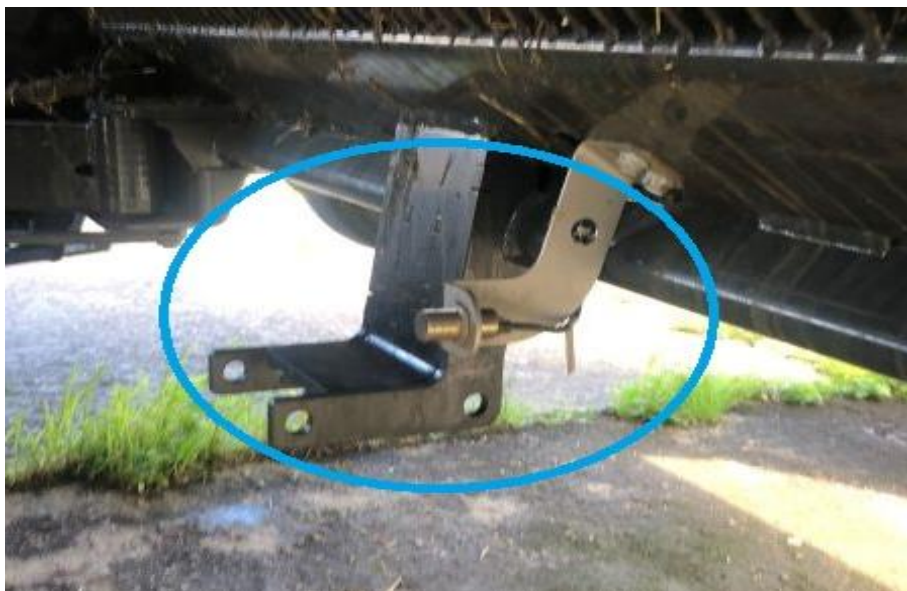
Senzor nosníku nožů. Při špatném zajištění nosníku nožů nelze nože zaklopit do komory vozu.
