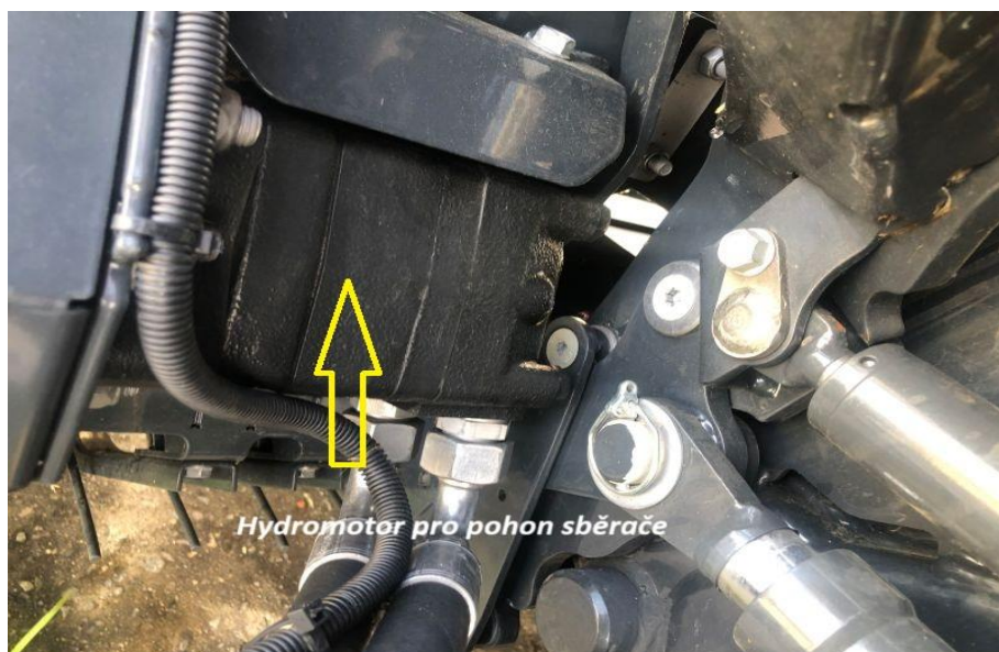
Pohon sběrače. Nový hydraulicky nastavitelný pohon sběrače automaticky upravuje otáčky v závislosti na rychlosti pojezdu. Výsledkem je čistý sběrač bez podélného vyčesávání porostu.
