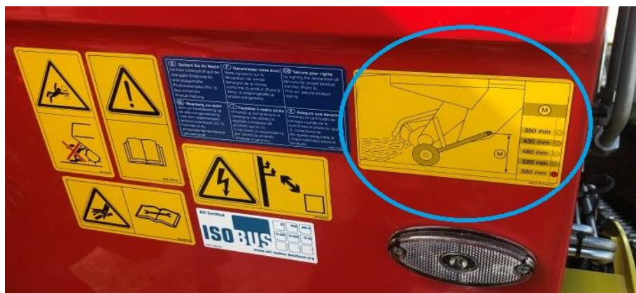
Hodnota pro nastavení pracovní výšky sběrače. Důležité pro dobré kopírování sběrače při práci.
