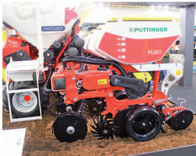
Plastový zásobník na osivo o objemu 68 litrů má ve spodní části uzavírací šoupátko, které umožňuje výměnu secích kotoučů i při plném zásobníku
