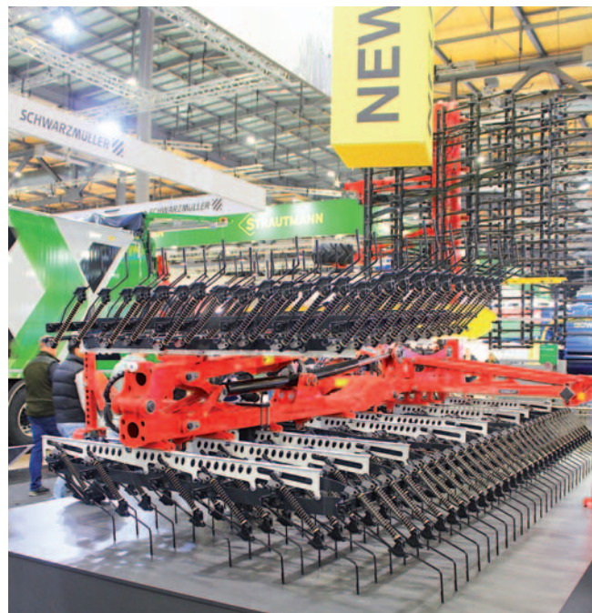
Tinecare V 12050 Master je vhodný pro všechny běžné polní plodiny. Díky šestiřádkému uspořádání a velké vzdálenosti mezi nosníky umožňují tyto prutové brány průchod velkého množství organické hmoty
