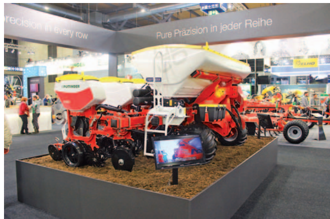
Přesný secí stroj Puro H 3000 měl pracovní záběr 4,5 m a šest výsevních jednotek pro rozteče řádků 75 cm. Zásobník na hnojivo má kapacitu 1300 litrů
