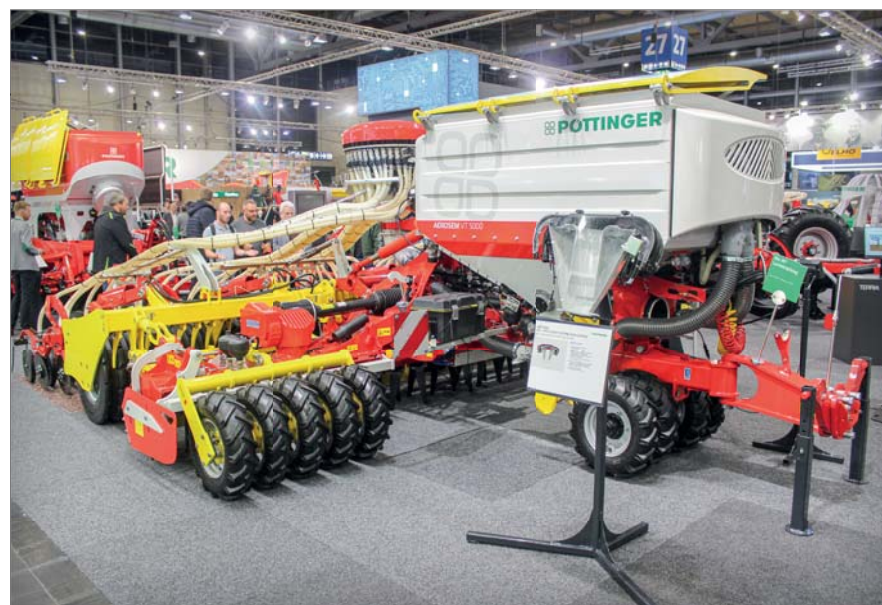
Kombinace Pöttinger Aerosem VT lze nyní vybavit i komfortním ovládáním Profiline. Stroj je zásobován olejem pouze systémem Load Sensing traktoru a veškeré nářadí je ovládáno elektrohydraulicky přes hydraulický blok
