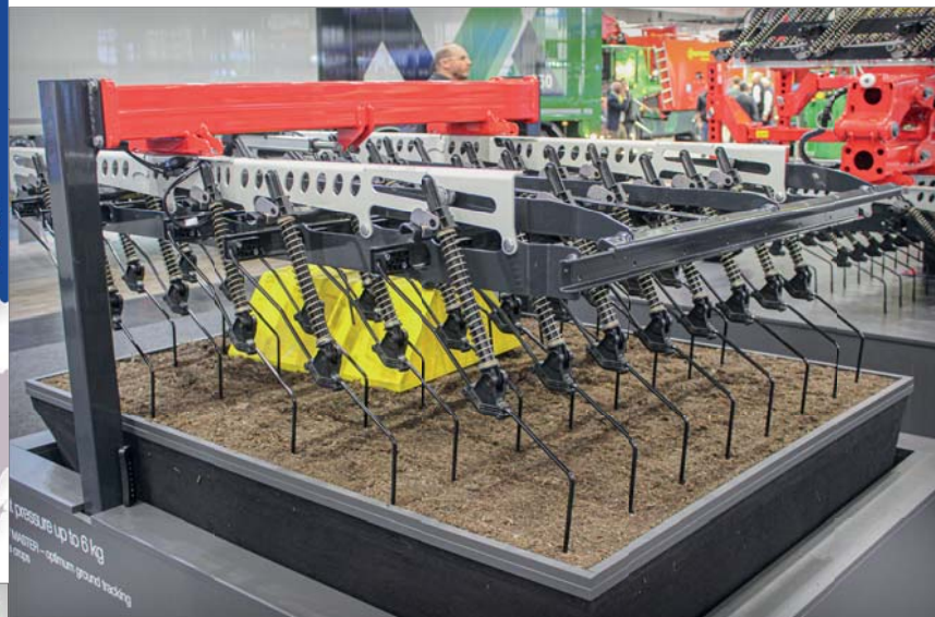
Díky šestiřádkému uspořádání a velké vzdálenosti mezi nosníky umožňuje Tinecare V 12050 Master průchod velkého množství organické hmoty
