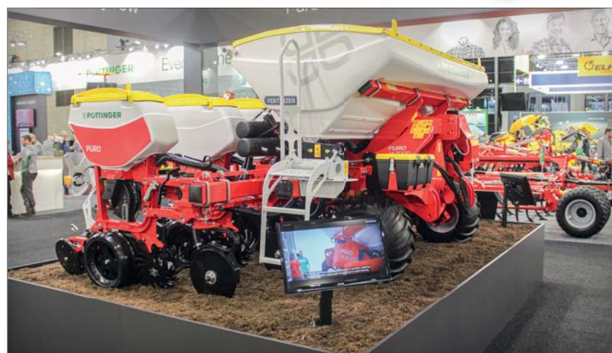
Přesný secí stroj Puro H 3000 měl pracovní záběr 4,5 m a šest výsevních jednotek pro rozteče řádků 75 cm. Zásobník na hnojivo má kapacitu 1300 litrů
