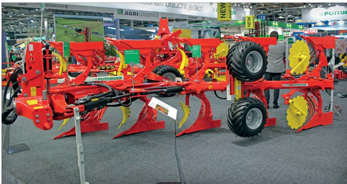
Řada Servo 4000 jsou těžké nesené pluh s rámem o profilu 140 x 140 mm a pro traktory s výkonem až 360 k
