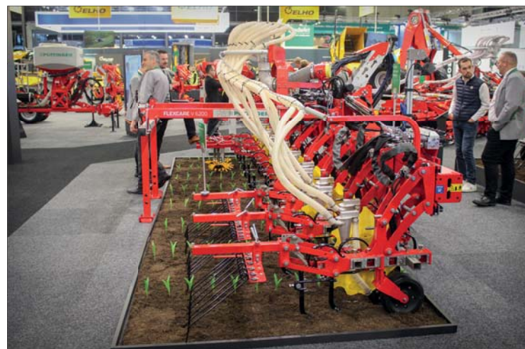
Nejdůležitější novinkou u plečky Flexcare V je pneumatický rozdělovací systém, který ve spojení se zásobníkem umožňuje například cílenou aplikaci hnojiv současně s kultivací porostu
