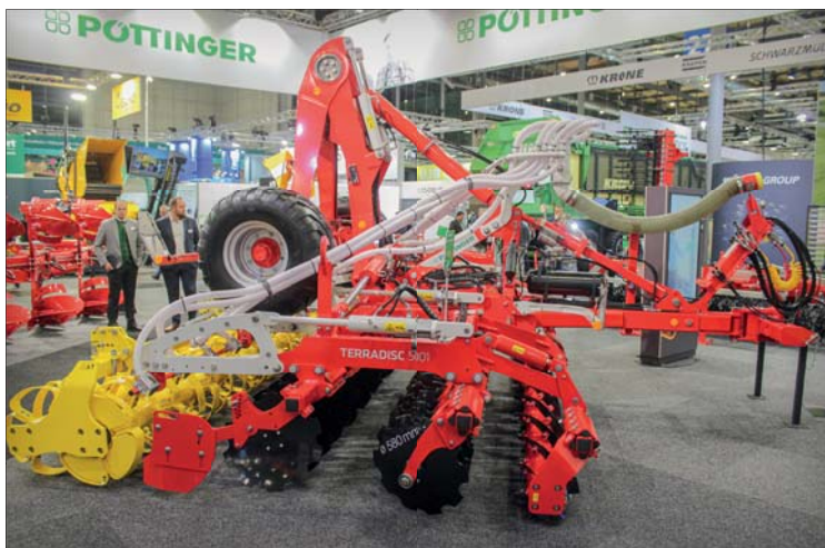
Sloučení operací zpracování půdy a setí meziplodin dovoluje polonesený talířový podmítač Terradisc 5001, doplněný o rozdělovací hlavu a semenovodné hadice, vyústěné před opěrným válcem
