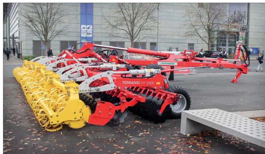
Na volné ploše před pavilónem 13 se hrdě vyjímala novinka, talířový podmičák Pöttinger Terradisc HT 12000 s pracovním záběrem 12,5 m
