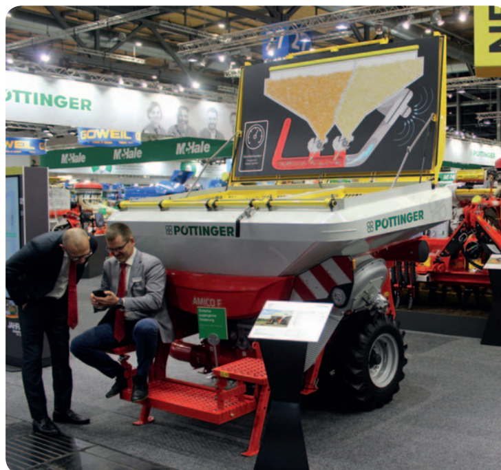
Čelně nesený zásobník Amico F výborně poslouží jako místo pro uložení osiva pro nový nesený secí stroj Aerosem F 3000 DD
