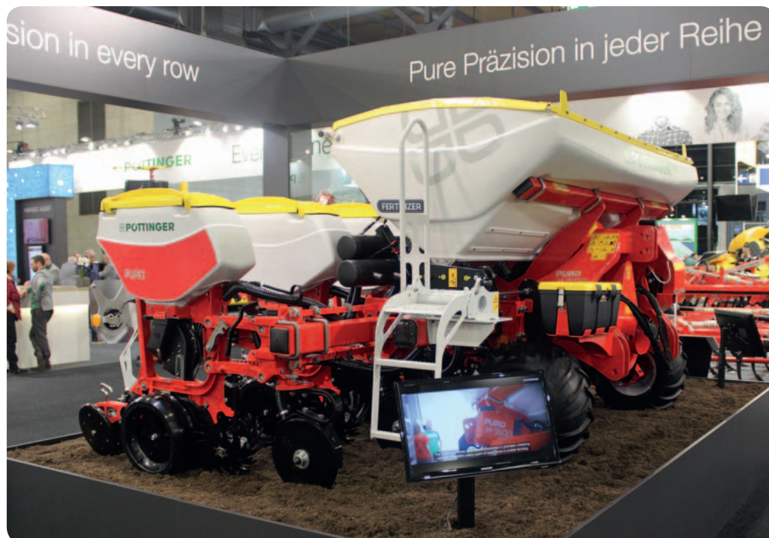
Přesný secí stroj Puro H 3000 měl pracovní záběr 4,5 m a šest výsevních jednotek pro rozteče řádků 75 cm. Zásobník na hnojivo má kapacitu 1300 litrů
