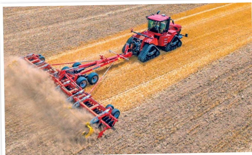
Stávající osvědčené modely Terradisc 8001 T a Terradisc 10001 T se záběrem osm, resp. deset metrů nyní doplňuje nový model podmiítače Terradisc HT 12000 s pracovním záběrem 12,5 metru
