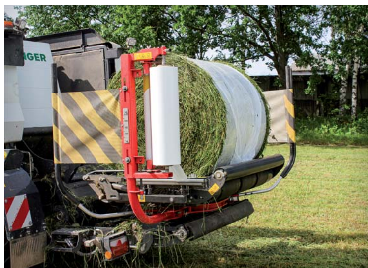
Ovíječka má svá robustní ramena poháněná odspodu. Předávání balíku se ukázalo jako spolehlivé, a to i ve svazích
