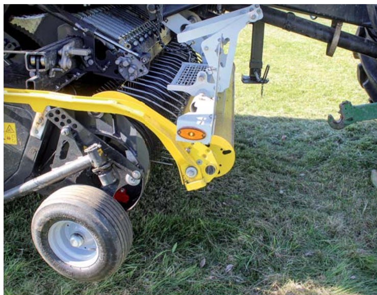
Lisy Pöttinger Impress mají řízený sběrač s výkyvným uložením. Píce je aktivně dopravována pomocí celé délky prstů až těsně před rotor. Prsty se ponoří svisle do vodících pásů, takže nedochází ke vtažení píce do válce sběrače
