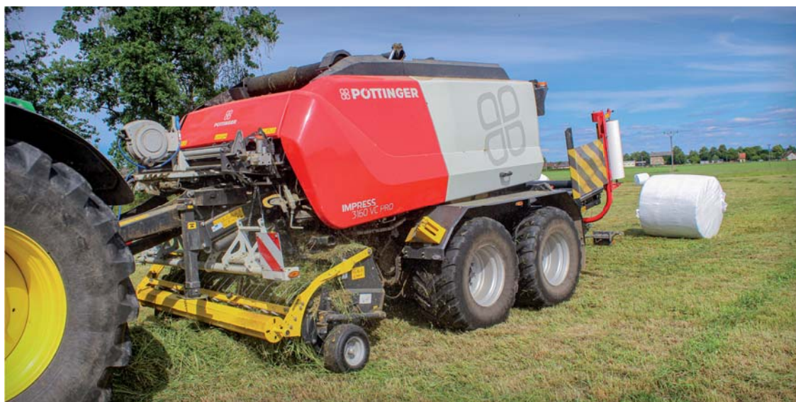
Při sklizni zavádě travní píce se zvýšenou vlhkostí na poloviční počet 16 nožů činila spotřeba paliva 14 až 15 litrů za hodinu
