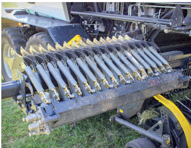
Na výsuvném nosníku nožů Easy Move se nechá s noži manipulovat pohodlně vestoje. Lisy Pöttinger Impress ve verzi Pro disponují 32 noži, vždy se samostatným jištěním
