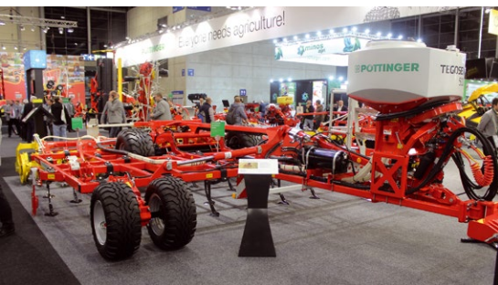
Vystavený kypřič PLANO VT 6060 byl doplněn o sečí stroj TEGOSEM 500, dovolující současně seti mezplodiny se zpracováním půdy.
