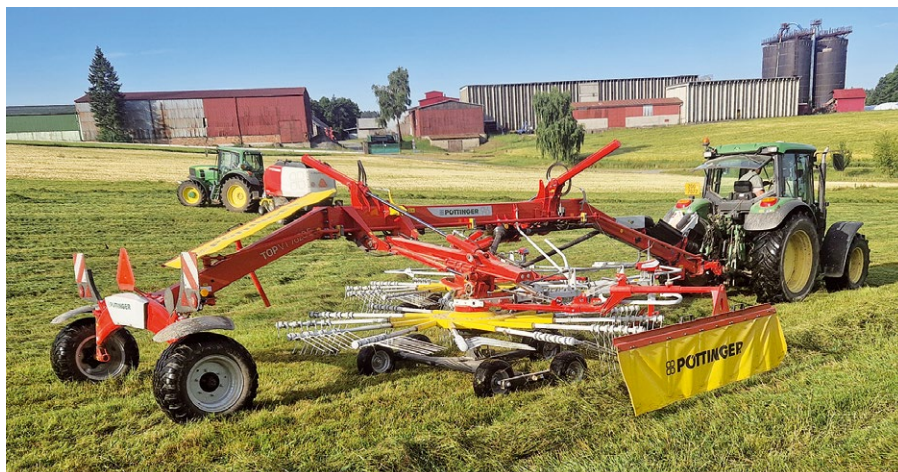
Nejnovějším strojem na farmě je dvourotorový stranový shrnovač TOP VT 7620 S se záběrem 7,60 m. Čelní kolečka MULTITAST výrazně zlepšují kopírování nerovností, což je základ pro čisté a šetrné shrnování.
