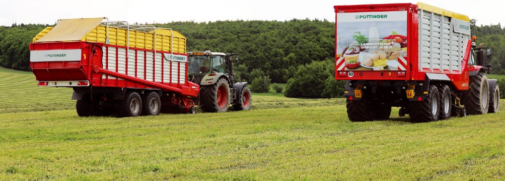
Novým senážním vozem JUMBO 5370 DB (vůz vpravo) lze píce sklízet ještě kvalitněji a efektivněji. Pohyblivá čelní stěna zajišťuje maximální využití ložného prostoru vozu i urychlení vykládky.
