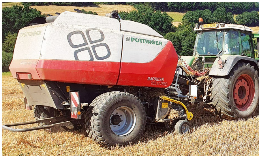
Lis IMPRESS 155 V PRO pracuje v agregaci s traktorem 200 k. Václav Jindrák s ním lisuje převážně seno a slámu. Za sezonu udělá kolem 5 000 balíků.
