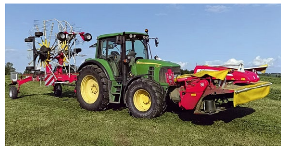
Čelní žací lišta NOVACAT 301 F ED ALPHA MOTION s prstovým kondicionérem a dvourotorový tažený shrnovač píce se středovým odkládáním řádku TOP 762 C. U shrnovače Tomáš Ondruch oceňuje manévrovatelnost, výborné kopírování, šetrnou manipulaci s pící a schopnost tvořit rovnoměrné vzdušné řádky.
