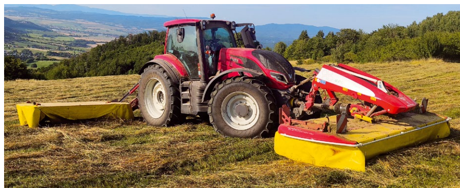
Disková žacia kombinácia NOVADISC 812 s čelne neseným diskovým žacím strojom NOVACAT 351 ALPHA MOTION PRO má záber 8,08 m.
