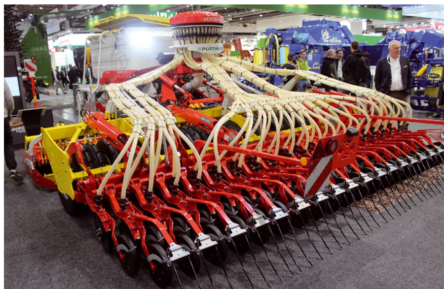
Vystavený secí stroj AEROSEM VT prezentoval i rozdělovací hlavu IDS, která má všechny vývody osiva ovládané pomocí BUS systému. Tak lze zvolit rozteče kolejových řádků podle potřeby a nezávisle na pracovním záběru secího stroje. Vždy v závislosti na tom, jaký počet vývodů je otevřený, resp. zavřený, je redukováno množství dávkovaného osiva včetně sekčního řazení.
