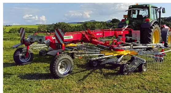
Čelní žací lišta NOVACAT 301 F ED ALPHA MOTION s prstovým kondicionérem a dvourotorový tažený shrnovač píce se středovým odkládáním řádku TOP 762 C. U shrnovače Tomáš Ondruch oceňuje manévrovatelnost, výborné kopírování, šetrnou manipulaci s pící a schopnost tvořit rovnoměrné vzdušné řádky.
