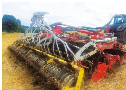
Širokozáběrový diskový podmiťáč TERRADISC 8001 T s pneumatickým secím strojem s čelním zásobníkem AMICO F na osivo nebo hnojivo. Zásobník má dvě komory a dvě secí ústrojí, takže pěstitelé mohou současně set dvě různé mezplodiny, například vikev a svazenu. Komory mají celkový objem 2 400 litrů v poměru 60:40.
