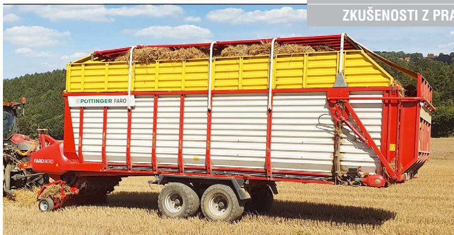
Samosběrací vůz s válcovým vkládacím ústrojím FARO 8010 L pro efektivní manipulaci se suchým krmivem, senem a slámou. Je vhodný pro traktory s výkonem 90 až 150 k.
