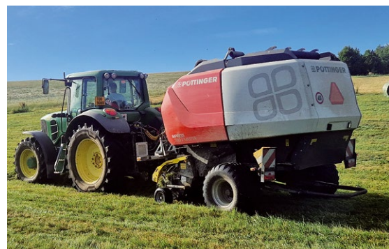
Lis na kulaté balíky s variabilní komorou IMPRESS 3160 V MASTER zpracoval za čtyři sezony kolem 6 000 balíků sena, senáže a slámy.
