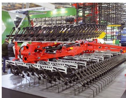
Díky šestiřádemu uspořádání a velké vzdálenosti mezi nosníky umožňuje TINECARE V 12050 MASTER průchod velkého množství organické hmoty.
