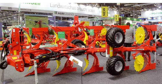
Osvědčený systém Traction Control umožňuje cílené dotížení brzdového a záhonového kola zadní nápravy traktoru. Výsledná zvýšená trakce zaručuje efektivní postup v jakémkoli terénu, snižuje prokluz i nežádoucí zhutnění podorníční vrstvy půdy.
