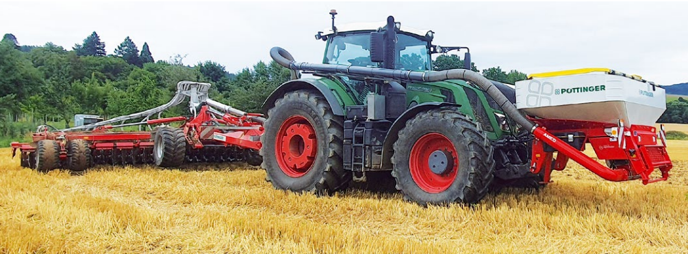
Širokozáběrový diskový podmiťáč TERRADISC 8001 T s pneumatickým secím strojem s čelním zásobníkem AMICO F na osivo nebo hnojivo. Zásobník má dvě komory a dvě secí ústrojí, takže pěstitelé mohou současně set dvě různé mezplodiny, například vikev a svazenu. Komory mají celkový objem 2 400 litrů v poměru 60:40.
