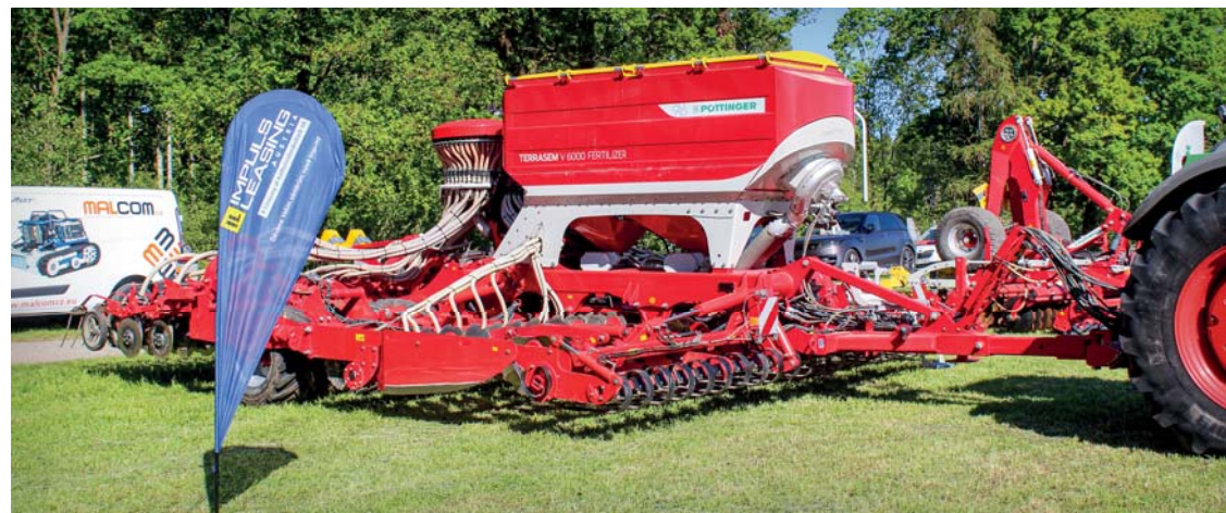
Pneumatické secí stroje Terrasem představil Pöttinger poprvé na podzim 2003. Od té doby jsou symbolem vývoje a zdokonalování secí techniky této značky
