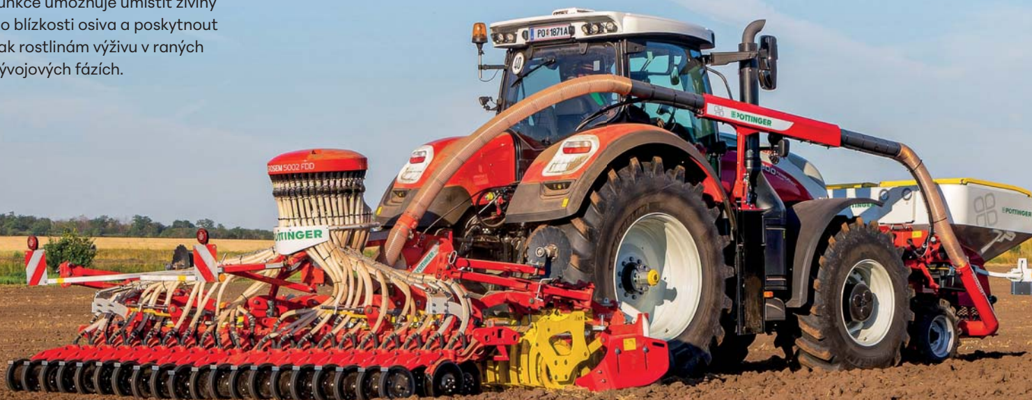
Po provedených inovacích je u secích strojů Aerosem FDD dostupný pracovní záběr pěti metrů v kombinaci s rotačními bránami Lion V 5040 a s roztečemi řádků 12,5 nebo 15,0 cm
