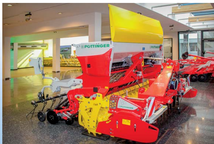
Secí stroje Vitasem nové generace mají větší objem zásobníku osiva. Oproti předchozí generaci se objem zásobníků jednotlivých modelů zvýšil až o 25 procent
