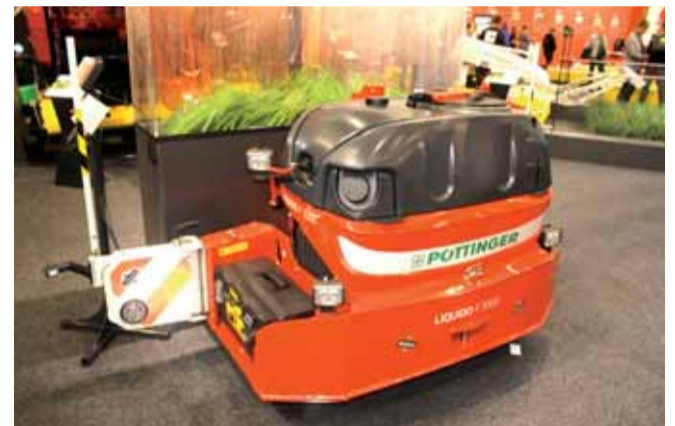
Nově vyvinutá a univerzálně použitelná nádrž na silážní přípravky Liquido F je čelně nesená na traktoru a nechá se velmi snadno plnit a obsluhovat, vše vestoje Foto Petr Beneš
