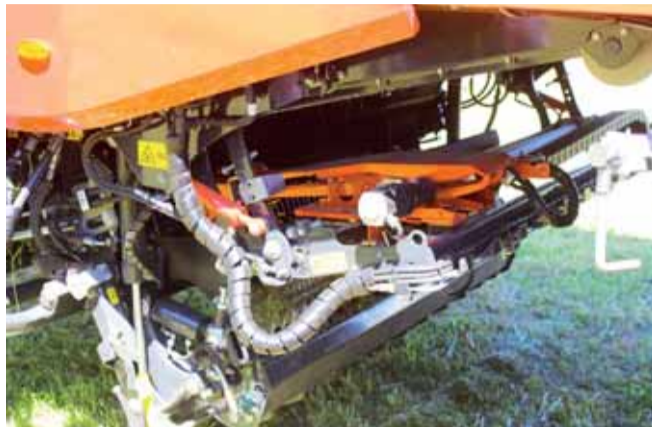
Brousící zařízení Autocut představuje efektivní způsob, jak využívat prostoje v provozu návěsu, a zajišťuje vyšší kvalitu řezanky při snížení spotřeby paliva traktoru Foto Petr Beneš
