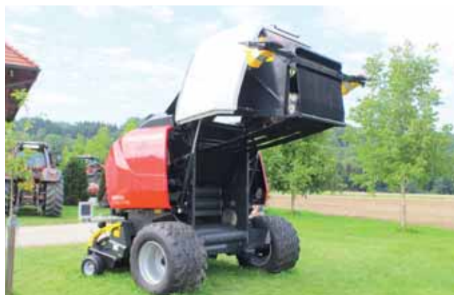
Kromě lisu Impress 3160 (na obrázku) se s variabilní lisovací komorou bude vyrábět také větší model Impress 3190 pro balíky o průměru až 190 cm Foto Petr Beneš
