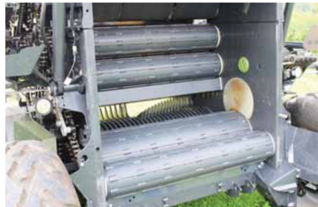
Lisovací komora je doplněna o senzory vlhkosti, takže obsluha traktoru má v reálném čase informace o vlhkosti sklizené hmoty Foto Petr Beneš
