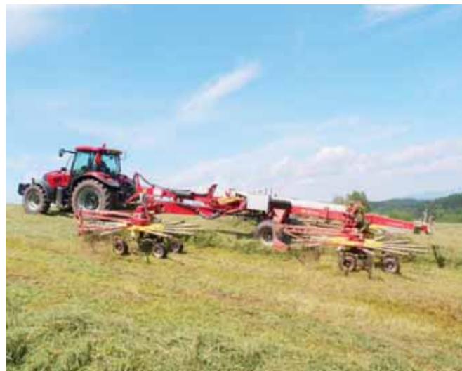
Na startu kariéry techniky Pöttinger stál středový shrnovač TOP 1252. Perfektní kopírování půdy u všech čtyř rotorů, souvratový management a snadné ovládání se v praxi ukázaly jako důležité přednosti Foto archiv
