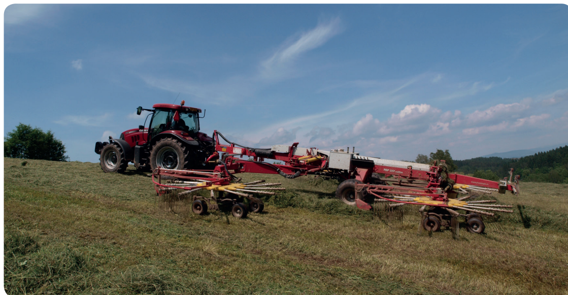
Velký čtyřrotorový shrnovač TOP 1252 se osvědčil zejména díky přesnému kopírování terénu, jednoduchému ovládní a vysoké výkonnosti
