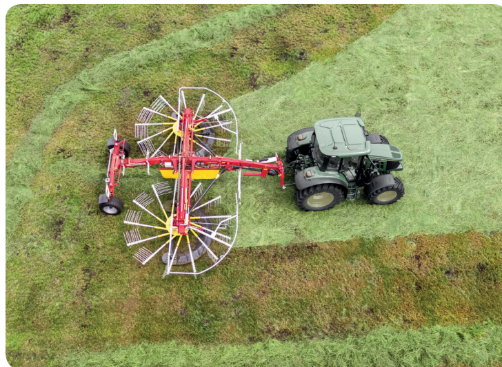
Dalším přínosem pro kvalitu sklizené píce v podniku AGROCHOV SOBOTKA je shrnovač Pöttinger TOP 882 C Flowtast, vybavený místo kol speciálními plazy
