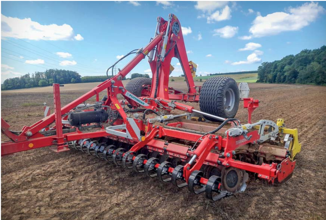
Talířový podmítač Pöttinger Terradisc 5001 T je doplněn o předřazenou smykovou lištu. Později pak byl přikoupen ještě řezací válec
