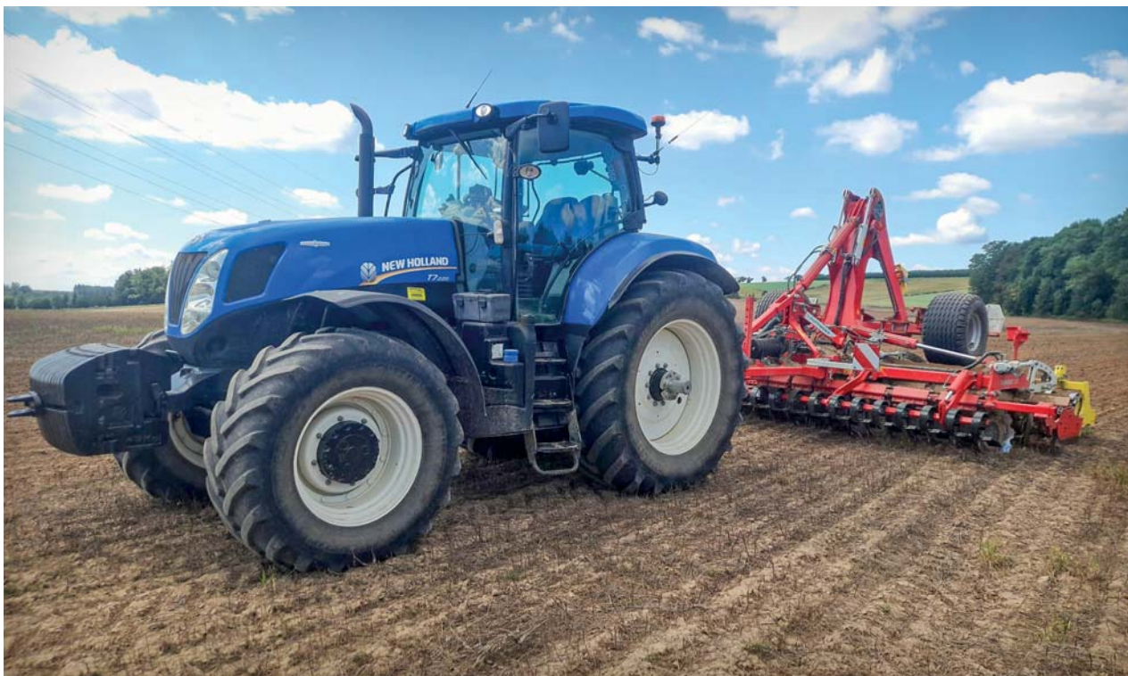
Při podmiťání s branami Terradisc 5001 T si majitel nastavuje pracovní hloubku pěti centimetrů, při přípravě půdy před setím pak osmi až dvanácti centimetrů. Spotřeba paliva přitom činí jedenáct až dvanáct litrů na hektar
