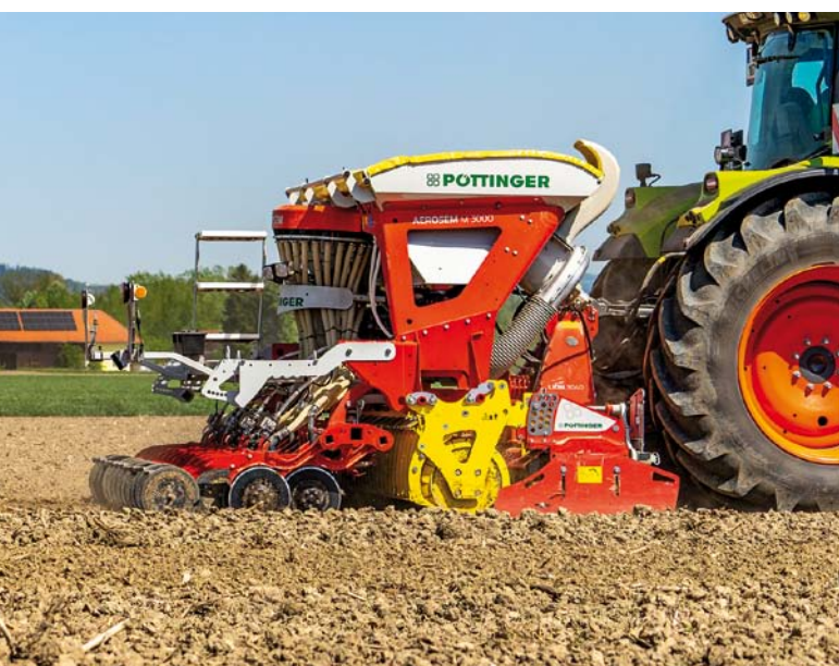
AEROSEM M v kombinácii s rotačnými bránami LION počas sejby sóje.
