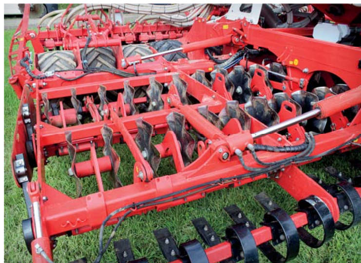
Talíře Wave disc zpracovávají drážku, určenou k uložení osiva, se šířkou zhruba 50 mm. Zbývající plocha zůstává bez zpracování, a tudíž bez ztrát vlhkosti. V oblasti nezpracované půdy zůstává vlhkost v půdě
