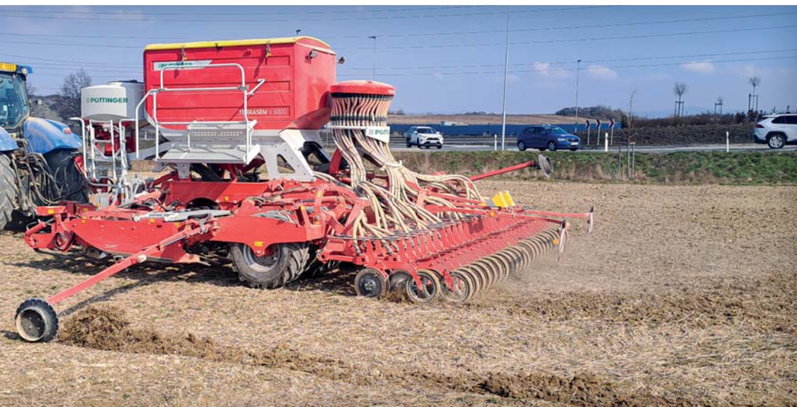
Na secím stroji Pöttinger Terrasem V 6000 D oceňuje jeho majitel stabilitu na poli i na silnici, vynikající vzházivost porostů, velkou kapacitu zásobníku osiva a funkce precizního zemědělství
