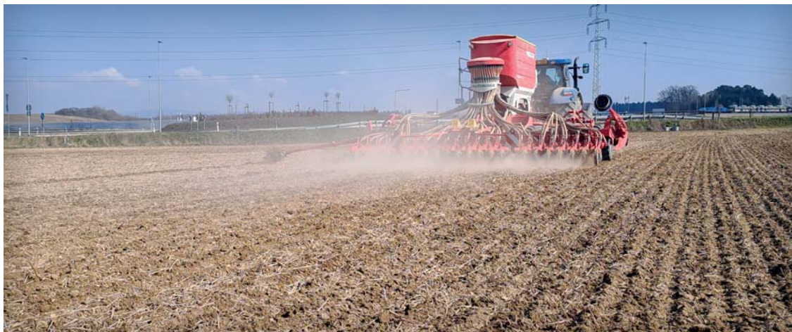
Secí stroj Pöttinger Terrasem V 6000 D pracuje bez jakéhokoliv stranového tahu. Je to dáno symetrickým uspořádáním talířů pro přípravu půdy, ale i dvoukotoučových secích btek
