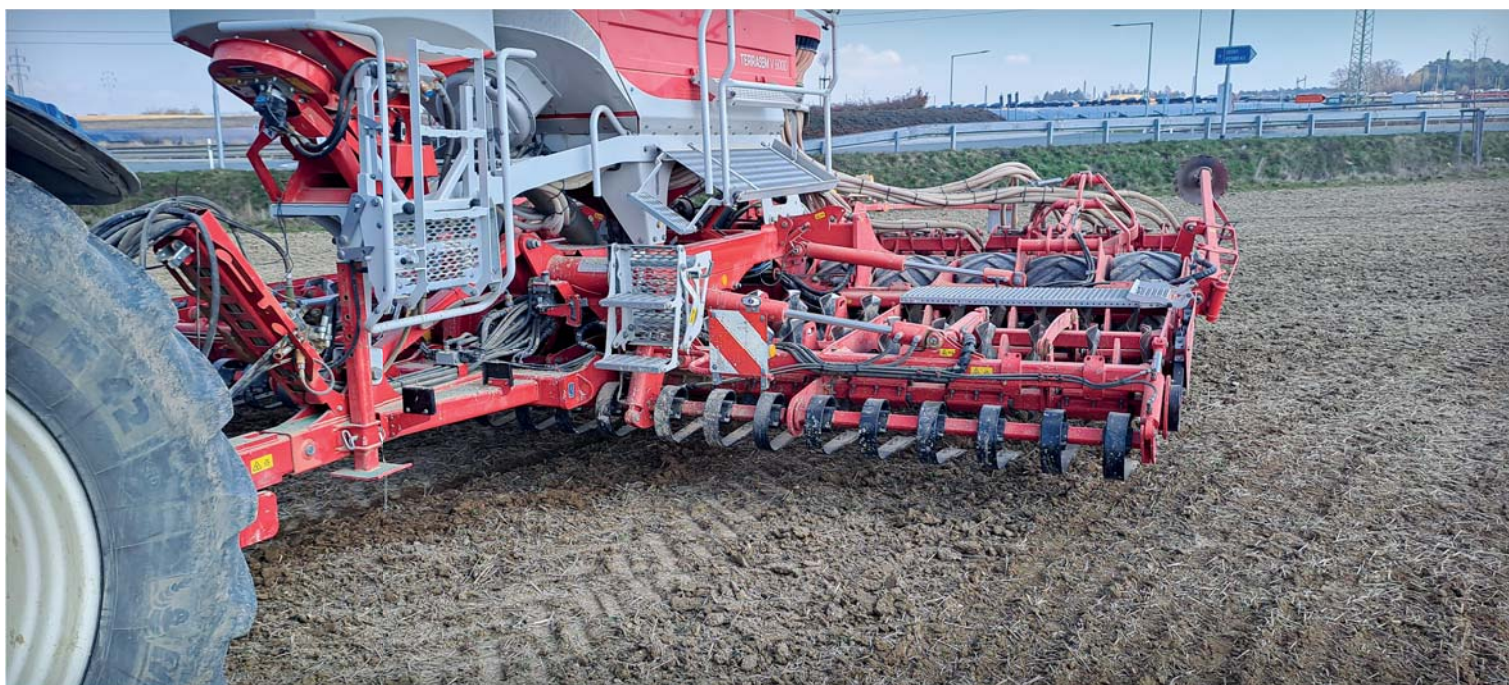
V místech, kde je třeba pozemek na povrchu ještě dorovnat, využívá Miroslav Bartoš předřazenou smykovou lištu. Tu si uvede do pracovní polohy hydraulicky povelom z kabiny traktoru
