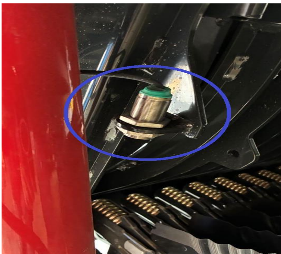
Senzor nosníku nožů – zajištění nožů.
