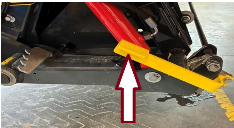
Páka na odjištění nosníku pro stranové vysunutí.
