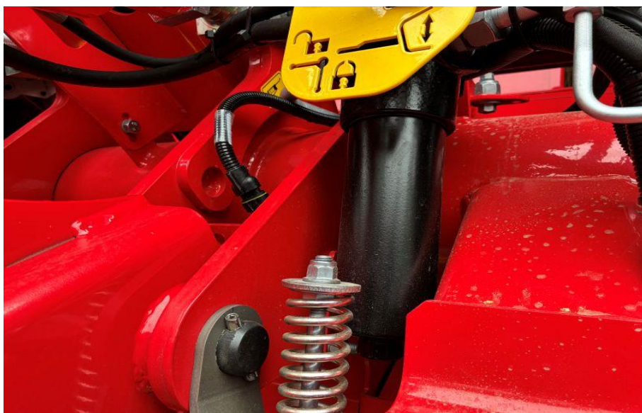
Hydraulický filtr. Doporučeno před sezonou provést výměnu vložky filtru.
