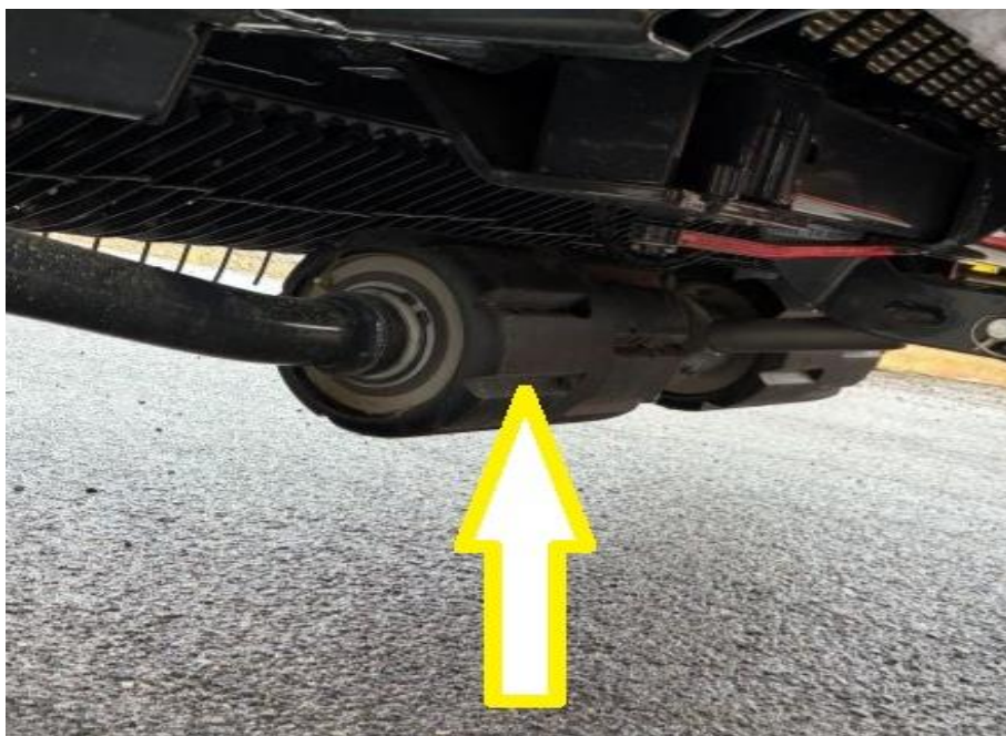
Kopírovací a opěrný válec sběrače má být nastaven o 2 cm výš, než je pracovní pozice kopírovacích kol sběrače.
