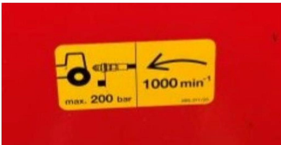
Hnací otáčky vývodového hřídele traktoru při práci musí být nastaveny na 1000 ot. /min.
