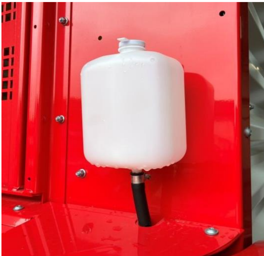
Nádržka oleje pro systém automatického mazání řetězů.
