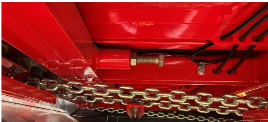
Napínání podlahového dopravníku.
