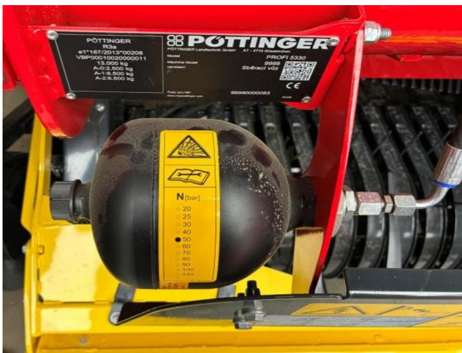
Dusíkový akumulátor odpružení tažné oje.
