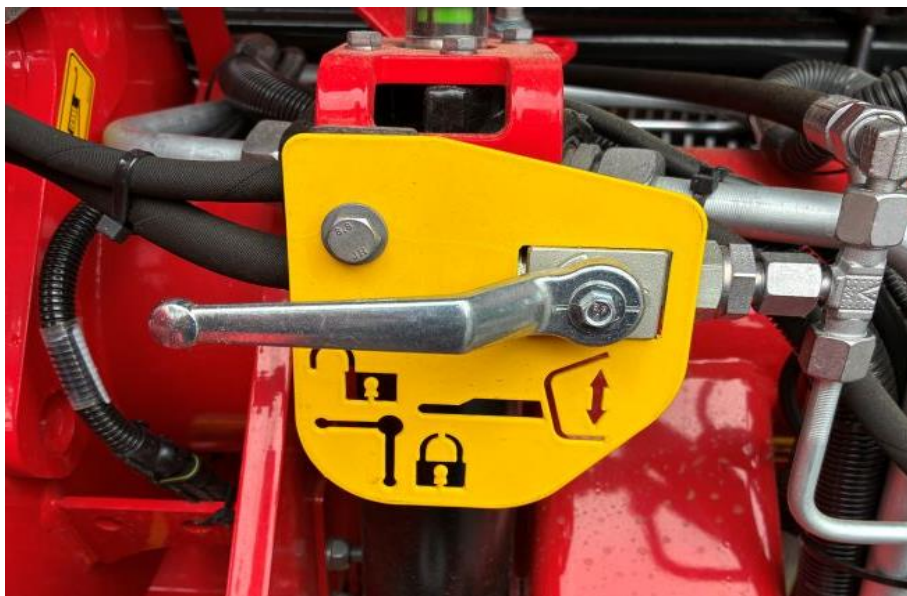
Ventil pro zajištění tažné oje proti pohybu.
