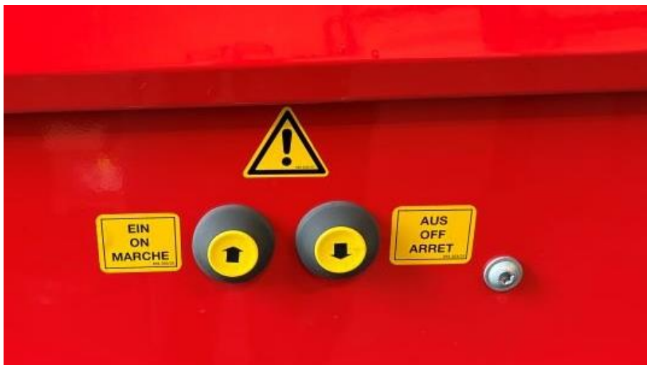
Tlačítka na odklopení a přiklopení nosníku nožů.
