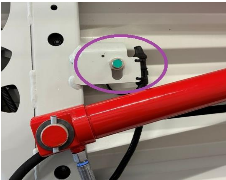
Senzor uzavření zadní stěny.
