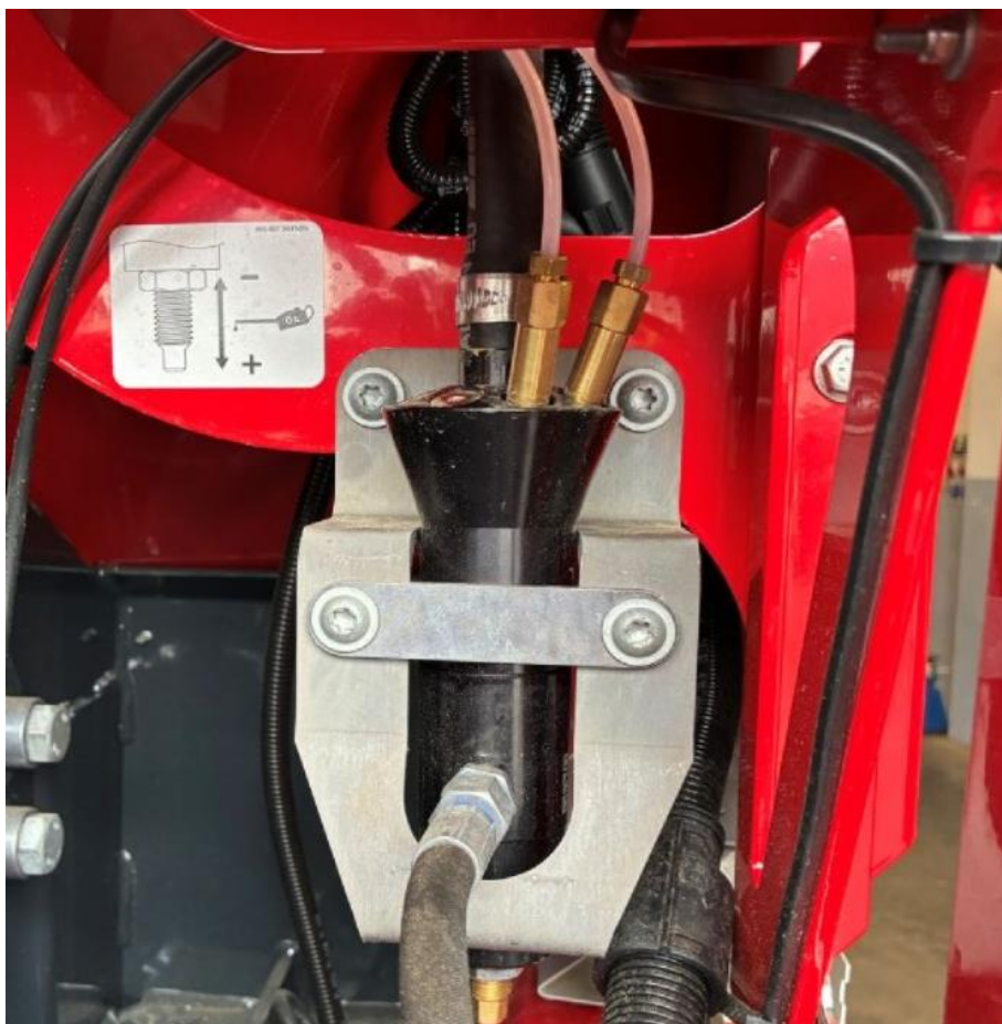
Čerpadlo pro automatické mazání řetězových pohonů.
