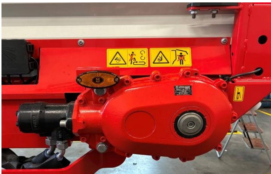
Hydromotor a převodová skříň pro pohon podlahového dopravníku.
