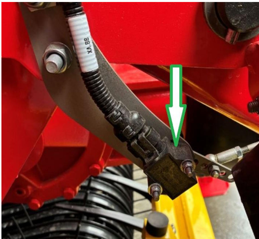
Senzor nastavení výšky tažné oje.
