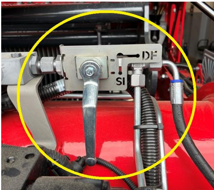
Ventil pro nastavení plné fůry. Dvě možnosti nastavení - senáž na SI a suchá píce a sláma na DF.
