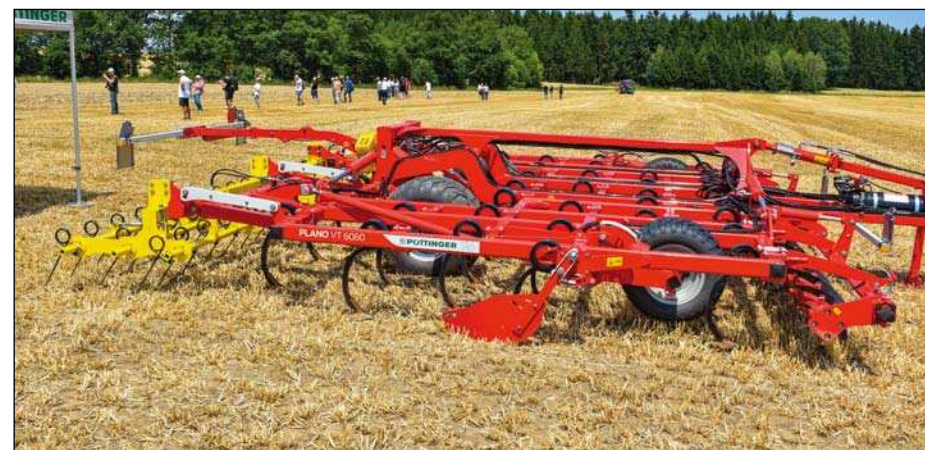
Jednou z nových funkcií sú vysokovýkonné prsty v zadnej časti kypriča PLANO, ktoré je možné nasaď na miesto zadného valca.
