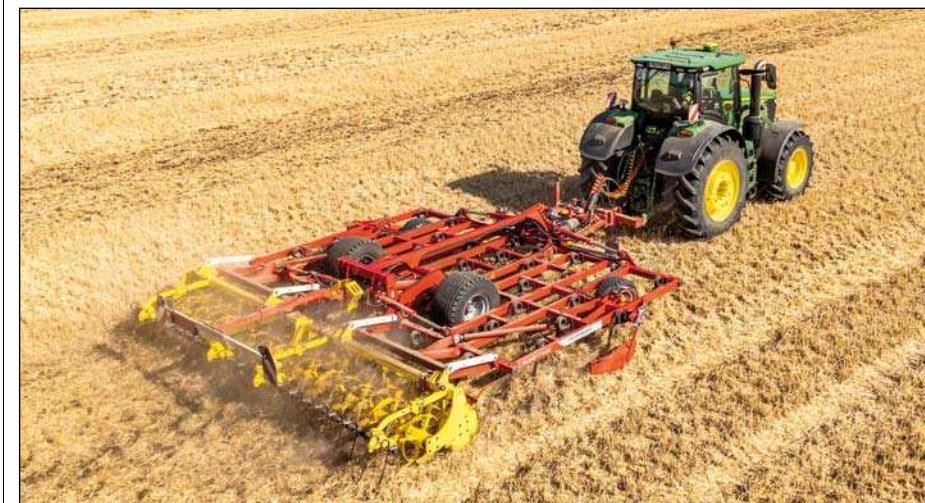
Radličkový kyprič Pöttinger PLANO je ideálnym na podmienku po zbere plodín aj prípravu sejbového lôžka, s pracovnou hĺbkou do 15 cm.
