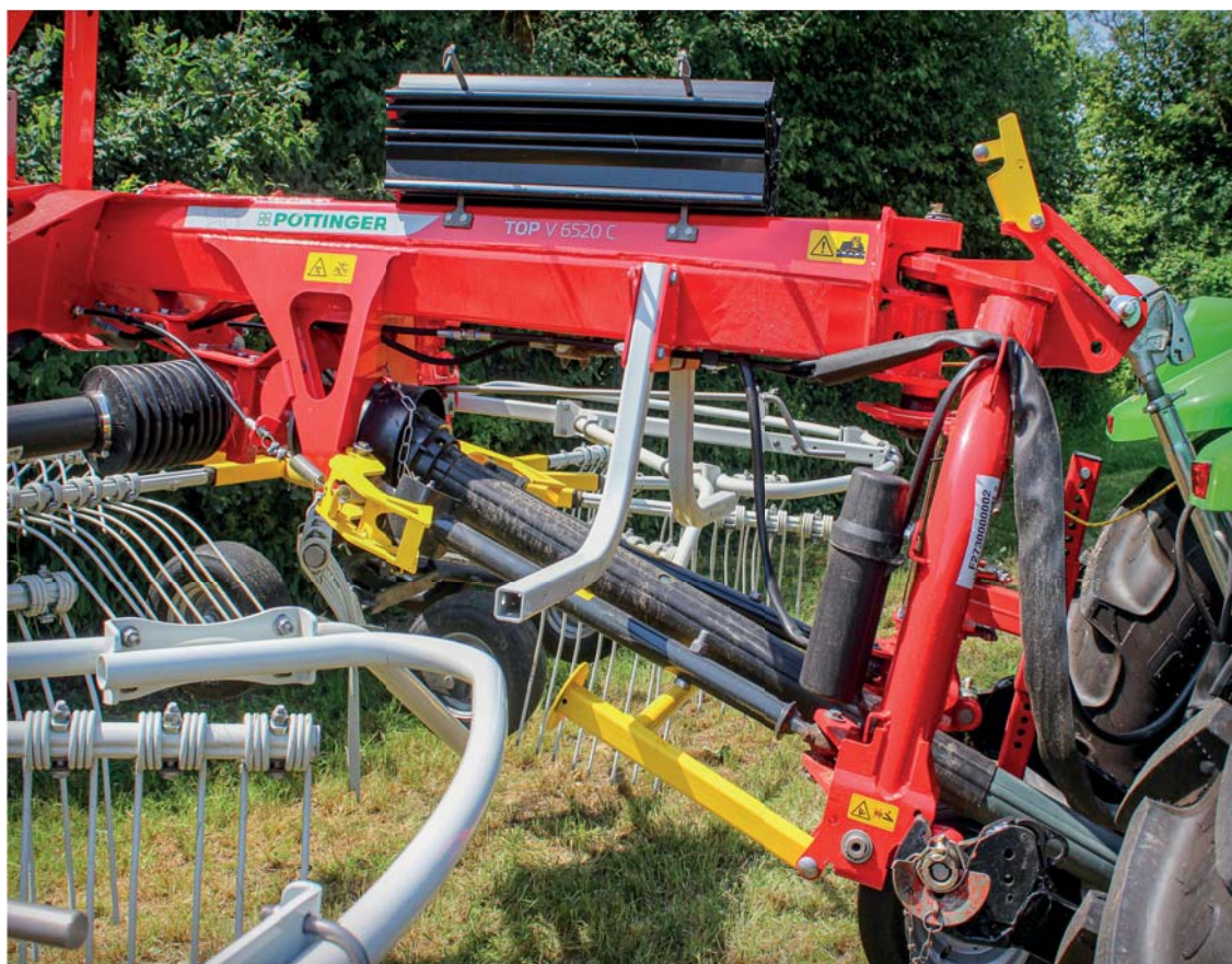
Při otáčení na souvrati se shrnovač Pöttinger TOP V 6520 C automaticky vycentruje ve středové poloze
