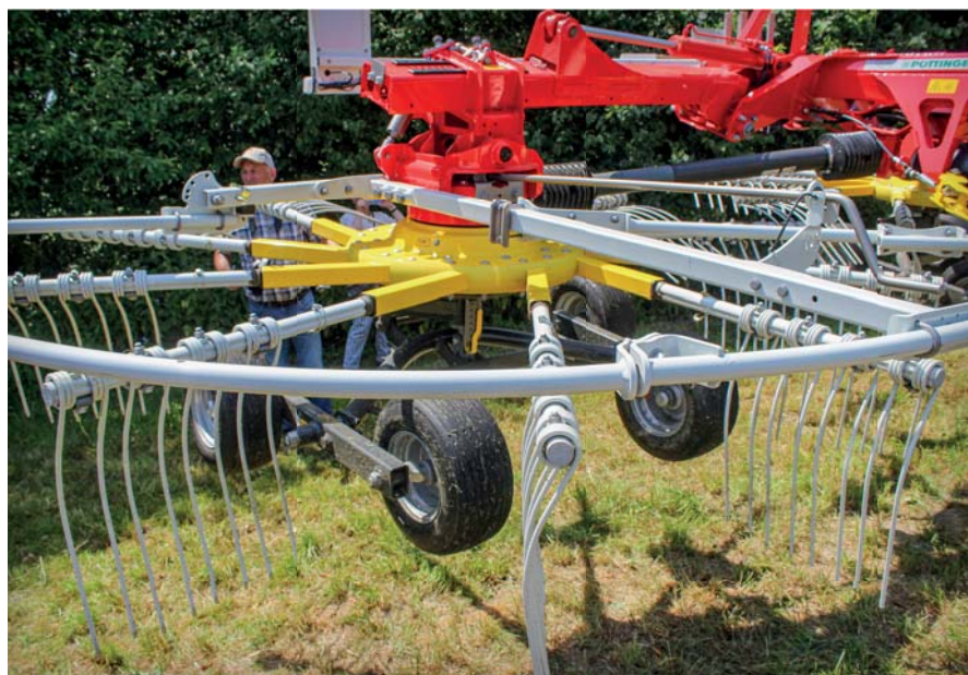
Každý rotor se plynule přizpůsobuje terénu díky svému tandemovému podvozku. Zavěšení rotoru je výkyvné s možností posouvání na nosníku za účelem mechanického nastavení šířky záběru
