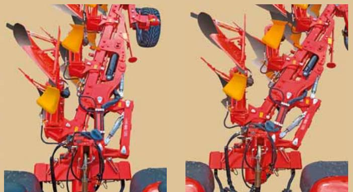
**SERVO plus Verstellsystem mit außenliegender Hebelanlenkung und Drehpunkt außerhalb des Rahmens**
