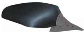
Langgezogener, gewundener und hoher Kunststoffkörper für Böden mit geringer Eigenstabilisierung. Breite Furchenräumung. Erdmaterial fließt leicht ab. Nur mit Schnabelschar zu verwenden. Nicht geeignet bei Steinbesatz.
