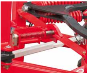
Verriegelung über einen Hydraulikzylinder mit Bolzen
