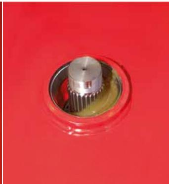
*Hochwertige Dauerschmierung durch Fließfett-Füllung*
