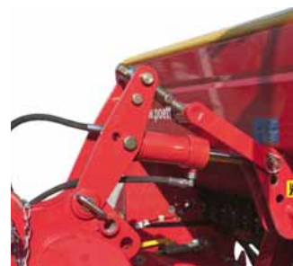
Univerzálny trojuholník pre agregáciu pneumatických sejacích strojov.
