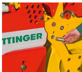
Al retirar los pasadores que fijan el rodillo, este queda conducido por sistema de paralelogramo.
