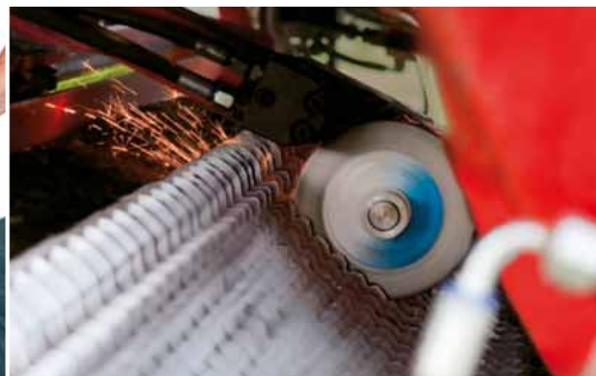
AUTO CUT – Sistema completamente automatico di affilatura dei coltelli, direttamente sul carro
