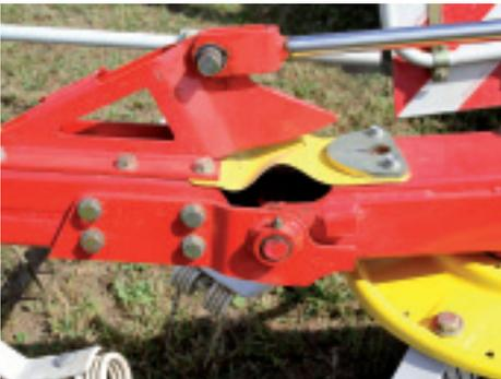
Die Traggelenke sind mit schmierbaren Verschleißbuchsen versehen, die Doppelgelenke sind wartungsfrei.
