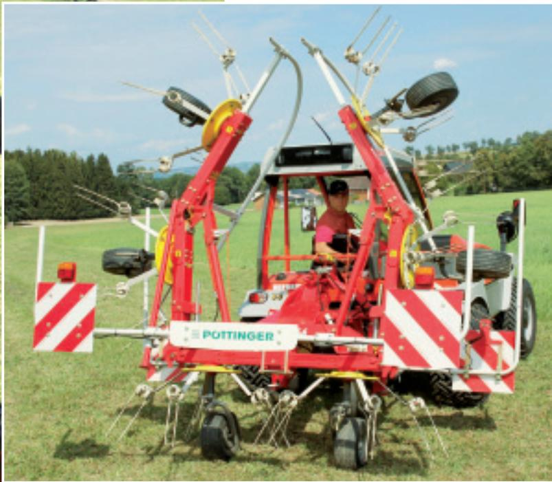
Der Alpinhit 6.6 ist für kleine Traktoren und insbesondere für den Einsatz mit Zweiachsmähern konzipiert.
