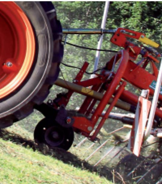
Das optionale Stützrad sorgt in Kombination mit dem starren Oberlenker für eine gute Boden Anpassung.
