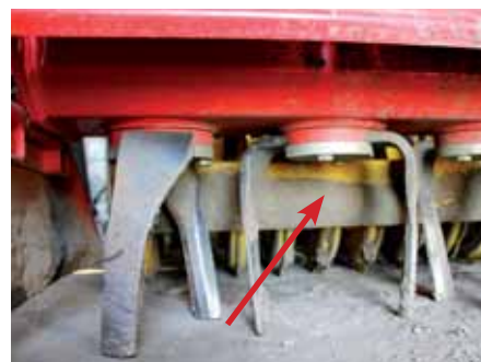
Janusz Bielarz opuszcza bronę na tyle, na ile zagłębiły się opony ciągnika. Zazwyczaj jest to ok. 6-8 cm. Maszyna posiada w tylnej części listwę wyrównującą.
