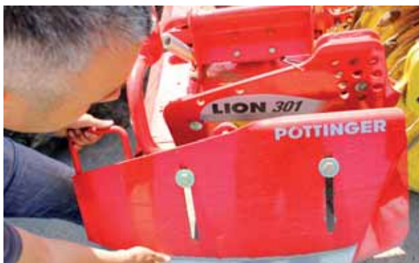
Boczne osłony brony aktywnej są zamocowane na sprężynach. Dzięki nim kamienie mają ułatwioną drogę ucieczki.
