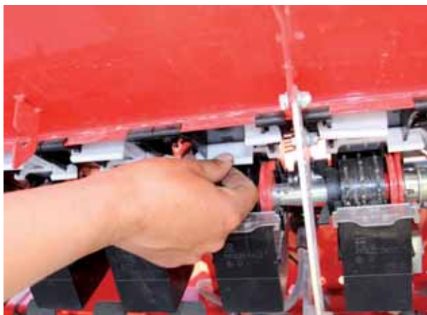
Prostota w czystym wydaniu dzięki aparatom wysiewającym o różnych kółkach. Aby wysiać nasiona drobne – zasuwamy zasłaniający kółka, które są niepotrzebne.
