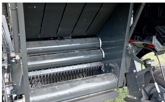
Die mit Druck schließende Presskammer besteht aus fünf Riemen und drei Walzen.
