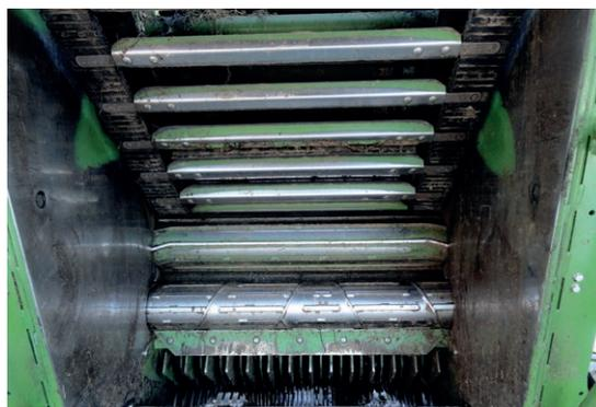
Der Stabgurtförderer wird über große, breite Umlenk- und Antriebsräder angetrieben.
