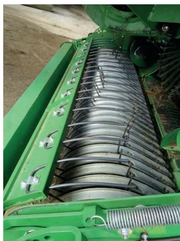
Ungesteuerte Pick-up: Die Zinken haben einen Abstand von 55 mm und sind W-förmig in fünf Reihen angeordnet.
