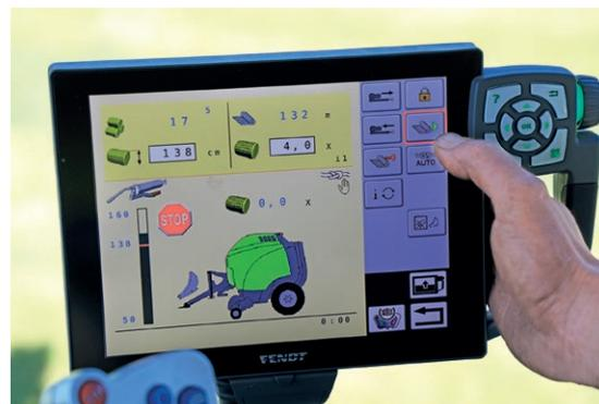
Wir bedienen alle Pressen über das ISOBUS-Terminal des Fendt-Traktors.
