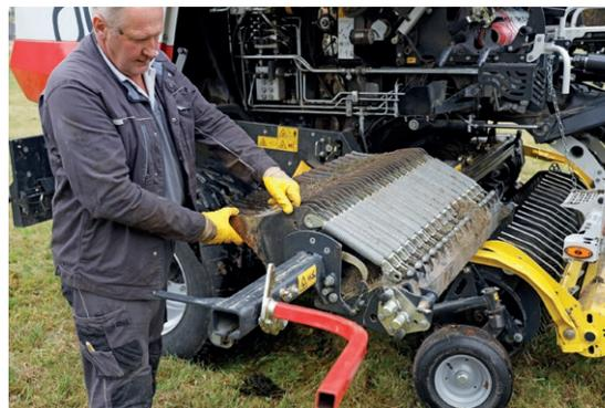
Einfacher und sicherer Messerwechsel dank ausziehbarem Schneidwerk.
