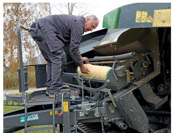
Die Netzbindung der Fendt Rotana funktionierte unter allen Bedingungen.
