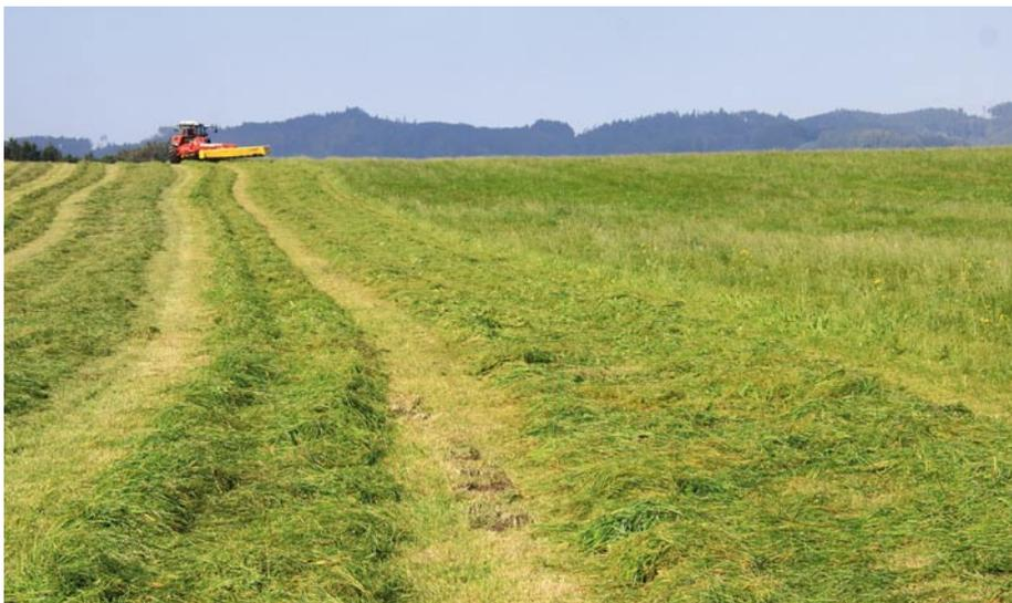
**Bis über 14 km/h und auch bei abgesenkter Zapfwelldrehzahl war die Schnittqualität einwandfrei. Die Ablage erfolgt als zwei Einzelschwade, wobei aufgrund der ungeraden Zahl an Mähscheiben im rechten Schwadbereich etwas mehr Material liegt.**
