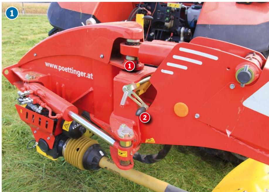
**1** Das Novacat 402 arbeitet mit einer hydraulischen Entlastung (1). Eine mechanische Sperre (2) blockiert das System beim Abstellen.
