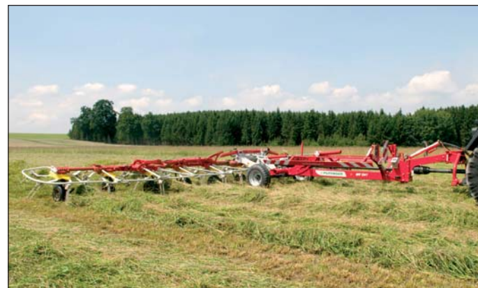
HIT 12.14 T – polonesené prevedenie s pracovným záberom 13,2 m.
