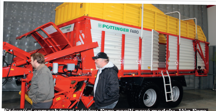
Stávající samosběrací návěsy Faro posílí nové modely. Vůz Faro 5010 L (na snímku) je vybaven zesíleným podvozkem, rámem i nástavbou. Menší model Faro 4010 L/D Combiline je doplněn čelní polohovatelnou klapkou. Hlavní změnou u obou modelů je vyšší univerzálnost využití v průběhu roku
