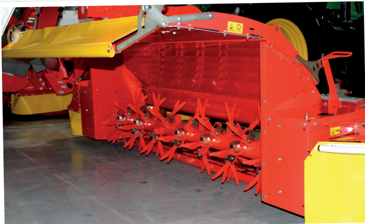
Také NovaCat X8 může být vybaven buď rotorem s prsty ve tvaru V (prstovým lamačem) nebo mačkáčimi válci. Prsty jsou uspořádány do spirály a mají elastické uložení v pružných prvcích
