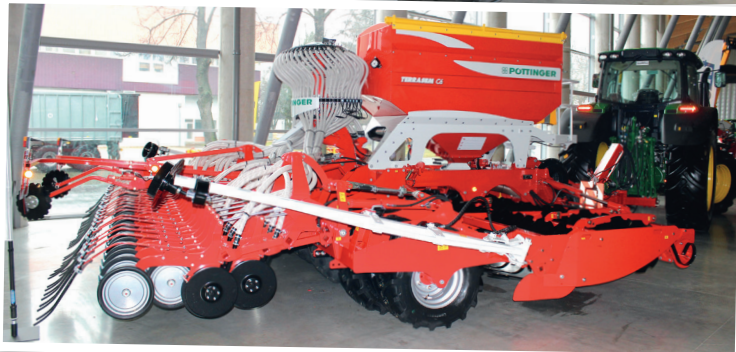
Středová opěrná a pěchovací jednotka secích strojů Terrasem je tvořena širokými pneumatikami, které se mohou otáčet samostatně, což vytváří efekt diferenciálu. Zároveň produkují i dostatečný přítlak na půdu pro kvalitní zpětné utužení, rozmáčknání hruď a formování výsevního lůžka. Zajímavostí jsou opěrná kolečka secích botek z plechu
