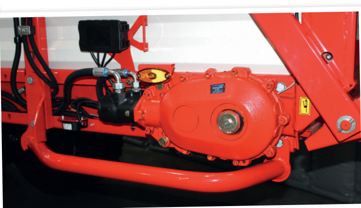
Senážní návěsy Faro mají překonstruovaný podlahový dopravník s vyšším výkonem. Pro plynulé vyprázdnění slouží dva páry řetězů, poháněných hydromotorem, který může být na přání v dvourychlostním provedení
