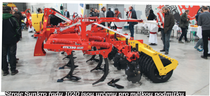
Stroje Synkro řady 1020 jsou určeny pro mělkou podmičku i k hlubšímu kypření půdy. Slupice v rozteči 45 cm lze osadit radličkami v různém provedení včetně nových odolných křídlových radliček Durastar. Ty jsou odolné opotřebení i v těžkých kamenitých podmínkách. Poškození slupice zabraňuje systém říštění Synkro Nova
