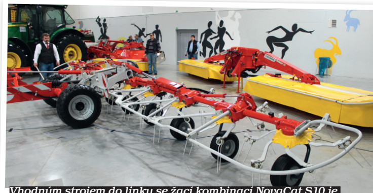
Vhodným strojem do linky se žací kombinací NovaCat S10 je tažený obrabeč HIT 10.11 T. Je osazen deseti novými rotory, které jsou v každé poloze pohyblivé. Vnější rotory se díky spojce mohou otočit o 180 stupňů. Rám obrabeče je tvořen dutou kulatinou v bílé barvě s vhodným systémem spojení
