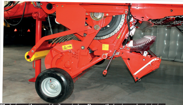
Plnění nového senážního návěsu Faro, stlačení a nařezání píce provádí rotor o průměru 750 mm, poháněný řetězem. Hvězdičky rotoru se šířkou 7 mm jsou vyrobeny z jemnozrnné borové oceli a protlačují píci po obou stranách nožů, kterých je ve výklopném nosníku celkem 31. Nosník lze vyklopit do strany a nože vyměňovat vestoje
