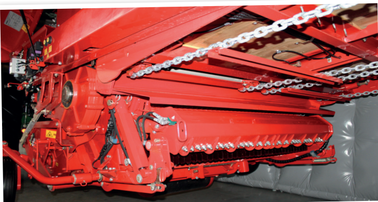
Na vystaveném modelu Europrofi 5510 Combiline prezentovala firma Pöttinger zdokonalenou konstrukci řezacího ústrojí: nosník nožů je odjistitelný z kabiny (nebo tlačítkem na levé straně vozu), poté se manuálně vyklopí do strany a následně se stiskem druhého tlačítka všechny nože uvolní.
