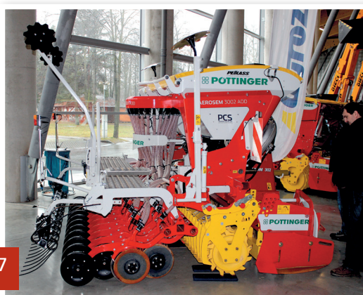
Secí stroj Aerosem 3002 ADD představil celou řadu pokrokových prvků. Pro rok 2015 se bude vyrábět i v pracovním záběru čtyř metrů. Vystavený model byl zapůjčen od zákazníka Jana Guta z Radošovic na Vlašimsku, který s ním na podzim zasel 45 hektarů ozimů, a letos plánuje i výsev kukuřice
