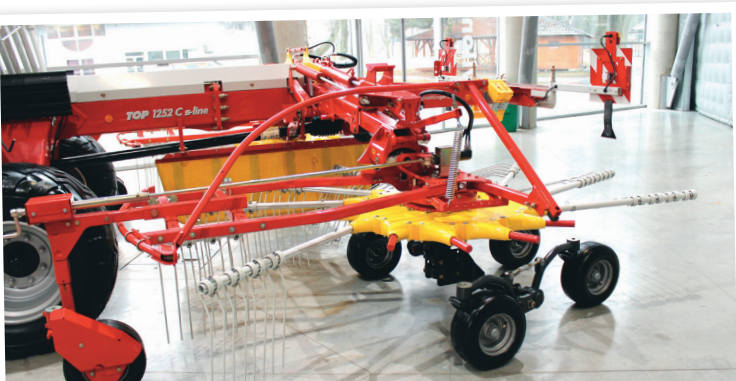
Největší čtyřrotorový shrnovač TOP 1252 C se přestavuje do přepravní polohy tak, že se rotory nejprve teleskopicky přiblíží k rámu a teprve potom se jejich ramena zdvihnou. Také z toho důvodu jsou kolečka rotorů uložena otočně na čepech. Celní kopírovací kolečko snímá terén těsně před dráhou prstů
