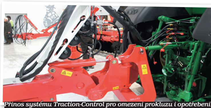
Jednoduchým strojem bylo nesené provedení krátkých talířových bran Terradisc 3001. Jde o vhodný model pro traktory s výkonem již 100 k, který má i nižší nároky na zvedací kapacitu zadního závěsu díky kónickému segmentovému válci o průměru 550 mm
