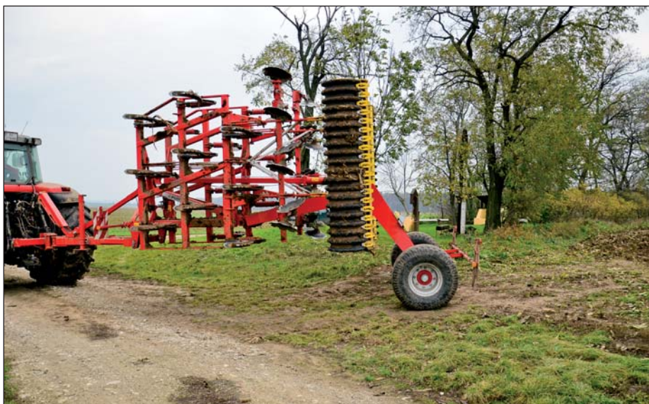
Na ceste sa ťahaná verzia prepravuje na podvozku s kolesami so šírkou 500 mm. Nízko položené ťažisko dovoľuje bezpečnú jazdu. Zmena z pracovnej do prepravnej pozície a naopak sa uskutočňuje bez nutnosti vychádzania vodiča z kabíny traktora.
