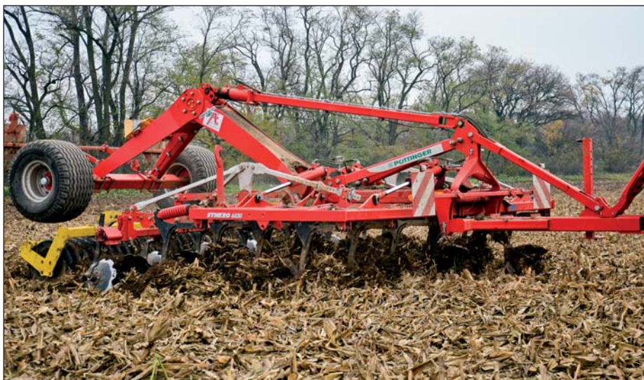
Výška rámu 85 cm a rozstup radličiek nebráni prechodu aj väčšieho množstva rastlinných zvyškov. Povrch pred valcami urovnáva rad tanierov s priemerom 45 cm.
