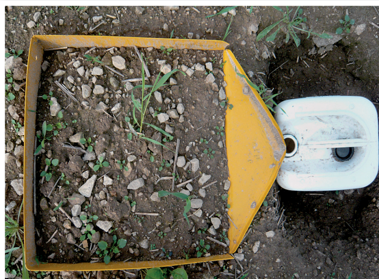
Obr. 1 – Odtoková mikroparcelka se záchytnou plochou 0,16 m 2
