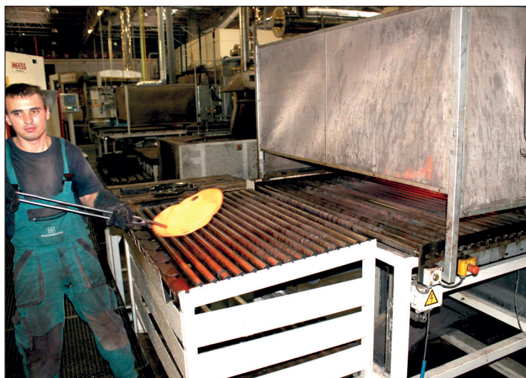
Továrna ve Vodňanech využívá dvě kalici a dvě popouštěcí pece. Kromě toho v ní funguje také moderní technologie indukčního kalení
