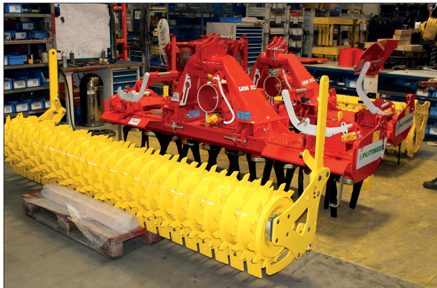
V ČR jsou rotační brány Lion nejprodávány v provedení se záběrem tří metrů. Při výrobě se osadí typem opěrného válce podle přání zákazníka
